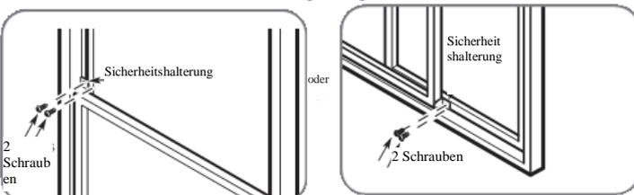
4. Falls gewünscht, montieren Sie die Sicherungshalterung mit 2 Schrauben wie abgebildet.
