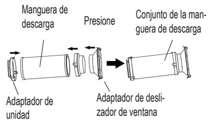
Paso Dos: Instale el conjunto de la manguera de descarga en la unidad
