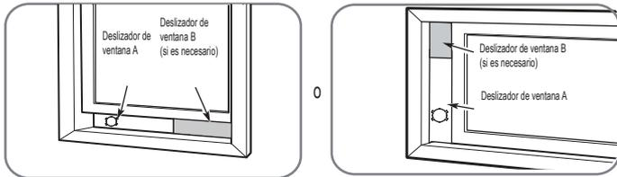
2. Inserte el conjunto del deslizador de ventana en la abertura de la ventana.
