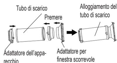
Secondo passo: Installare il tubo di scarico sull'apparecchio.
