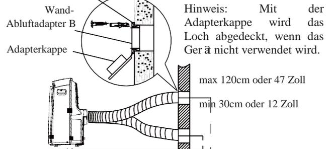
Hinweis: Um eine einwandfreie Funktion zu gewährleisten, dürfen Sie den Schlauch NICHT überdehnen oder verbiegen. Achten Sie darauf, dass sich kein Hindernis um den Luftauslass des Abluftschlauches (im Bereich von 500 mm) herum befindet, damit die Abluftanlage ordnungsgemäß funktioniert. Alle Abbildungen in diesem Handbuch dienen nur der Erläuterung. Ihr tatsächliches Klimagerät kann sich etwas unterscheiden. Es gilt die tatsächliche Form.
