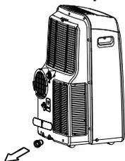
Mueva con cuidado la unidad hacia un lugar de drenaje, retire el tapón de drenaje y deje que salga el agua. Reinstale el tapón de drenaje y reinicie la máquina hasta que desaparezca el símbolo "P1". Si persiste el error, llame al servicio técnico. NOTA: Asegúrese de reinstalar el tapón de drenaje inferior
