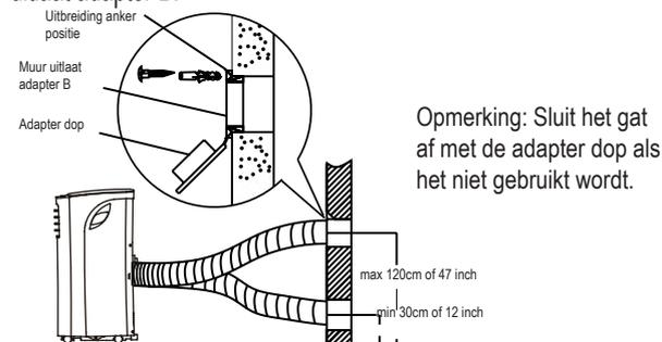
Opmerking: Om een goede werking te verzekeren mag de slang NIET worden overstrekt of gebogen. Zorg ervoor dat er zich geen obstakel rond de luchtuitlaat van de uitlaatslang bevindt (in het bereik van 500 mm) zodat het uitlaatsysteem naar behoren kan werken. Alle illustraties in deze handleiding zijn uitsluitend bedoeld ter referentie. Je airconditioner kan enigszins verschillen. De werkelijke vorm heeft voorrang.
