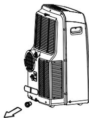
Déplacez délicatement l'appareil vers un emplacement d'évacuation, retirez le bouchon de vidange inférieur et laissez l'eau s'écouler. Réinstallez le bouchon de vidange inférieur et redémarrez la machine jusqu'à ce que le symbole « P1 » disparaisse. Si l'erreur se répète, contactez le service d'assistance.
