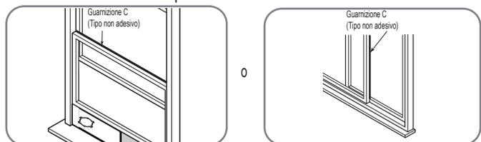
3. Tagliare una striscia di guarnizione non adesiva C in modo che corrisponda alla larghezza della finestra. Inserire la guarnizione tra il vetro e la cornice della finestra per evitare che aria e insetti entrino nella stanza.
