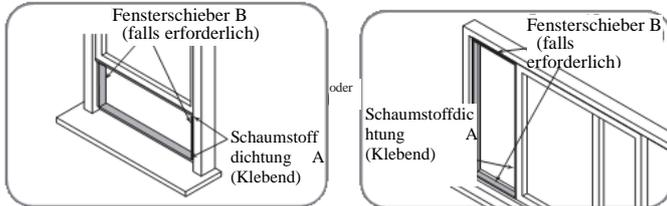
1. Schneiden Sie die klebenden Schaumstoffdichtungsänder A und B auf die richtige Länge zu und befestigen Sie sie wie abgebildet am Fensterflügel und am Rahmen.
