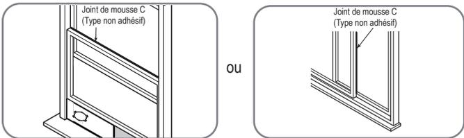
3. Coupez la bande de joint en mousse non adhésive C en fonction de la largeur de la fenêtre. Insérez le joint entre le verre et le cadre de la fenêtre pour empêcher l'air et les insectes de pénétrer dans la pièce.
