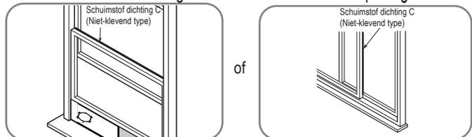
3. Snij de niet-klevende schuimstof dichting C-strip op de breedte van het venster. Plaats de dichting tussen het glas en het raamkozijn om te voorkomen dat er lucht en insecten in de kamer kunnen komen.
