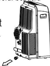
Verplaats het apparaat voorzichtig naar een afvoerlocatie, verwijder de onderste aftapplug en laat het water weglopen. Plaats de onderste aftapplug terug en herstart het apparaat totdat het "P1" - symbool verdwijnt. Als de fout zich blijft voordoen, bel je voor service. OPMERKING: Wees zeker dat u de onderste aftapstekker opnieuw geïnstalleerd is om lekkage te vermijden voor het gebruik van de eenheid.
