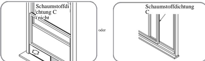
3. Schneiden Sie die nicht klebenden Schaumstoffdichtungsänder C entsprechend der Fensterbreite zu. Setzen Sie die Dichtung zwischen Glas und Fensterrahmen ein, um zu verhindern, dass Luft und Insekten in den Raum gelangen.
