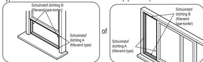
1. Snij de klevende schuimstof dichting A en B op de juiste lengte en bevestig ze op de raamlijst en het frame zoals getoond.
