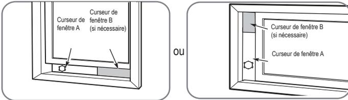
2. Insérez le curseur de la fenêtre dans l'ouverture de la fenêtre.
