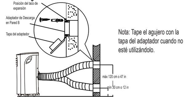
Nota: Para asegurar un funcionamiento correcto, NO sobreextienda ni doble la manguera. Asegúrese de que no haya obstáculos alrededor de la salida de aire de la manguera de descarga (en un rango de 500 mm) para que el sistema de descarga funcione correctamente. Todas las imágenes de este manual tienen sólo fines explicativos.
