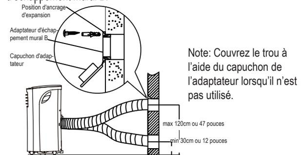
Note: Pour assurer un fonctionnement correct, NE PAS trop étendre ou plier le tuyau. Assurez-vous qu'il n'y a pas d'obstacle autour de la sortie d'air du tuyau d'échappement (de l'ordre de 500 mm) afin que le système d'échappement fonctionne correctement. Toutes les illustrations de ce manuel sont uniquement à des fins d'explication.
