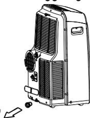
Sposta con attenzione l'apparecchio verso il luogo di scarico, rimuovi il tappo di scarico inferiore e lascia scaricare l'acqua di condensa. Riposiziona il tappo di scarico inferiore e riavvia l'apparecchio fino a che il simbolo "P1" non sarà spento. Se l'errore persiste, contattare l'assistenza. NOTA: Assicurati di aver riposizionato saldamente il tappo dello scarico inferiore per evitare perdita durante l'uso.
