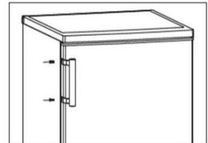
4. Schraublöcher mit den Abdeckkappen an der Seite verschließen, an der kein Türgriff montiert ist.
