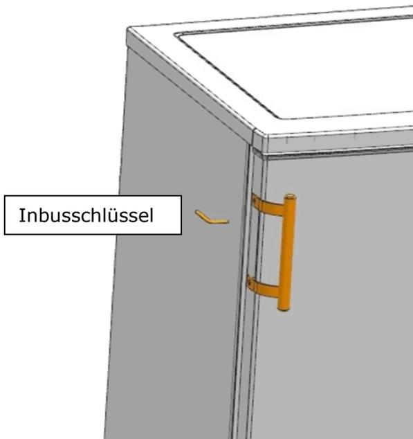
Den Handgriff mit den 2 beiliegenden Schrauben mit dem Inbusschlüssel (separat im Plastikbeutel) an der Gerätetür festschrauben.
