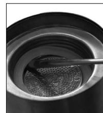
Desserrez le filtre et le joint torique sur le côté inférieur de la verseuse en glissant le manche d'une cuillère sous le joint torique et en retirant ce dernier.
