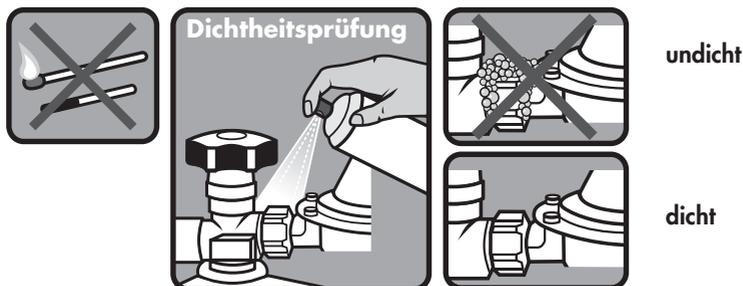
Abb. 3: Dichtheitsprüfung
