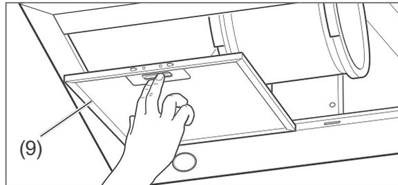
11. Schieben Sie die Verriegelung der Fettfilter (9) nach hinten und nehmen Sie die Fettfilter vorsichtig ab.
