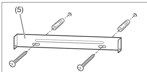
5. Schrauben Sie die Wandhalterung (5) mit zwei Schrauben an die Wand.
