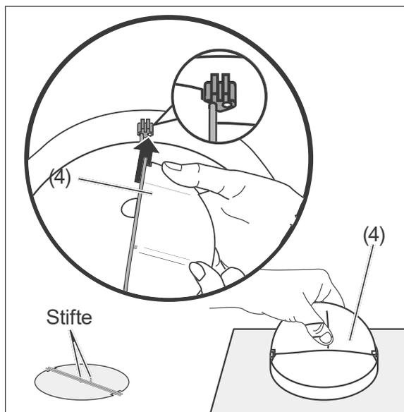
1. Setzen Sie beiden Hälften der Rückschlagklappe (4) in die Öffnung oben auf die Dunstabzugshaube. Achten Sie darauf, dass die Stifte auf den Klappen außen liegen.
