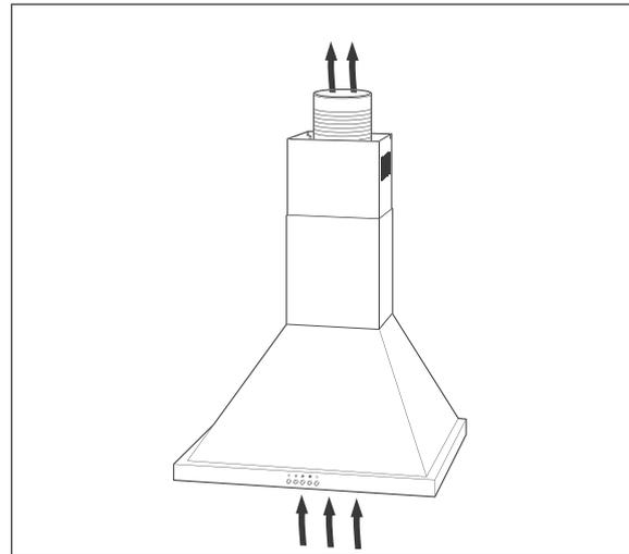
Beim Abluftbetrieb werden die Küchendünste angesaugt, über den Fettfilter gereinigt und über den Abluftschlauch ins Freie geleitet.
