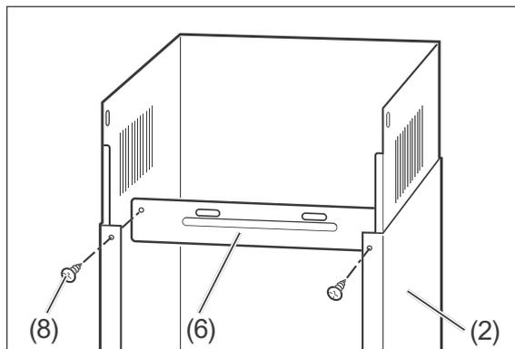
6. Schrauben Sie das Halteblech (6) mit zwei Schrauben (8) an die untere Hälfte der Kaminblende (2).
