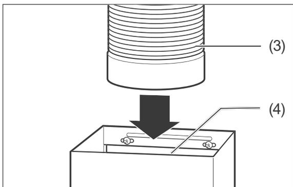
15. Nur bei Abluftbetrieb: SStecken Sie das Ende des Abluftschlauches (3) mit dem größeren Durchmesser (153 mm) auf den Anschluss mit der Rückschlagklappe (4).
