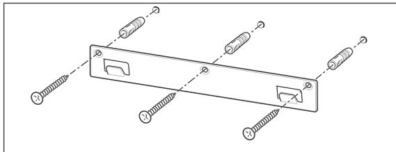
8. Stecken Sie die drei Dübel in die Bohrlöcher.
