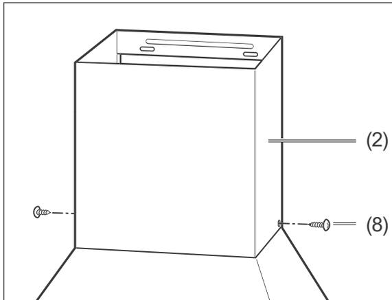
14. Schrauben Sie die Kaminblende (2) unten mit zwei Schrauben (8) an die Dunst-abzugshaube.
