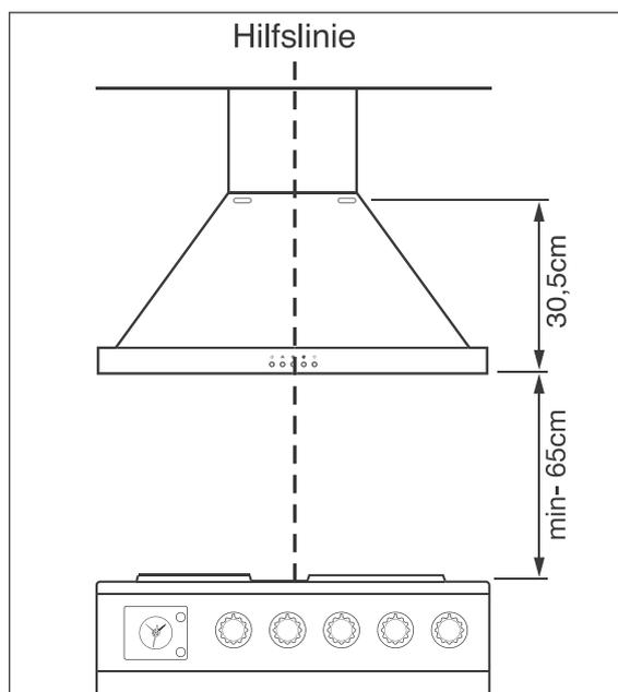
1. Um das Gerät exakt über der Mitte des Herdes platzieren zu können, zeichnen Sie mit dem Bleistift zunächst eine senkrechte Hilfslinie an die Wand. Verwenden Sie am besten eine Wasserwaage oder ein Lot von der Zimmerdecke bis zur Mitte des Herdes.
