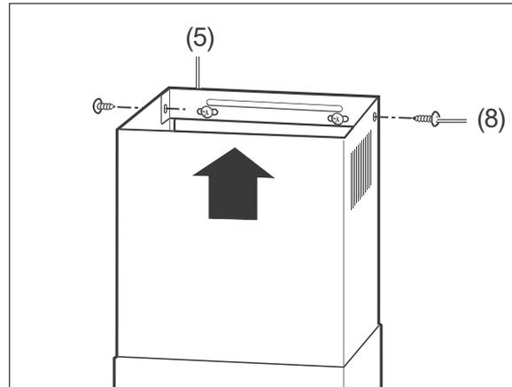
18. Ziehen Sie den oberen Teil der Kaminblende zur oberen Wandhalterung (5) herauf und schrauben Sie die Kaminblende mit zwei Schrauben (8) dort fest.
