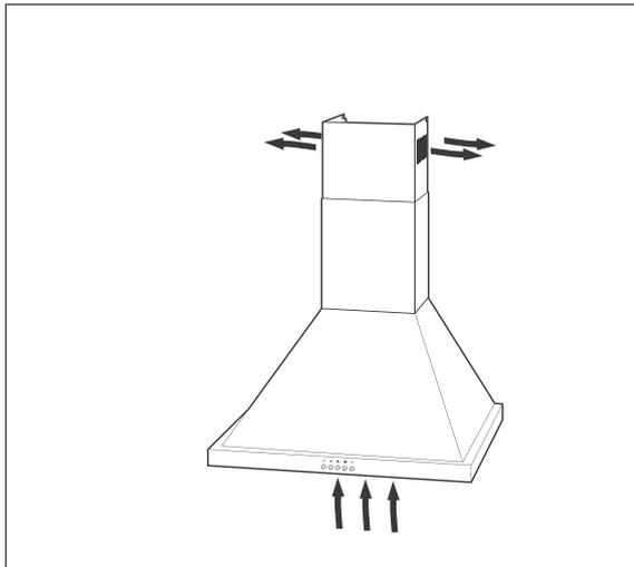
Beim Umluftbetrieb werden die Küchendünste angesaugt und nach der Reinigung durch die oberen Luftaustrittsöffnungen der Raumluft wieder zugeführt.
