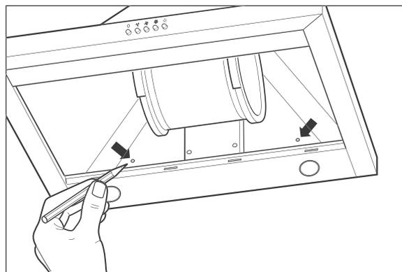
12. Zeichnen Sie die Bohrlöcher durch die Öffnungen im Geräteinneren an der Wand an.
