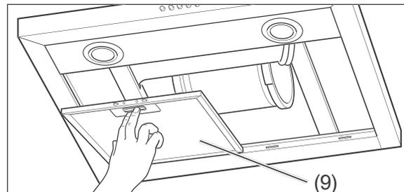
2. Schieben Sie die Verriegelung der Fettfilter (9) nach hinten und nehmen Sie die Fettfilter vorsichtig ab.
