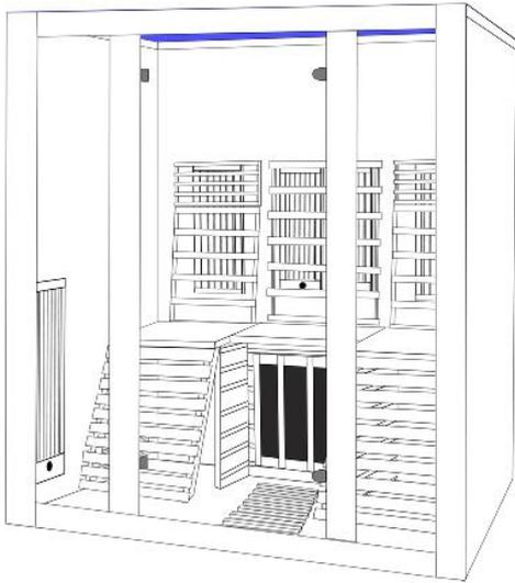
(14) Legen Sie die Deckenplatte auf die installierten Platten.
