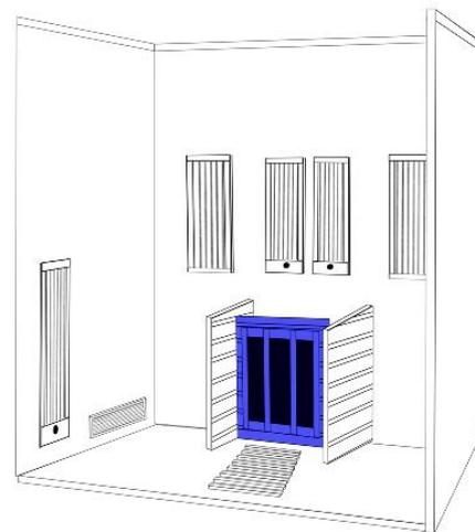
(5) Platzieren Sie die Bankauflageplatten in die Lücke der Holzlatten auf der Rückwand und schrauben sie mit Schraube M3,5\*40 an Bodenplatte.
