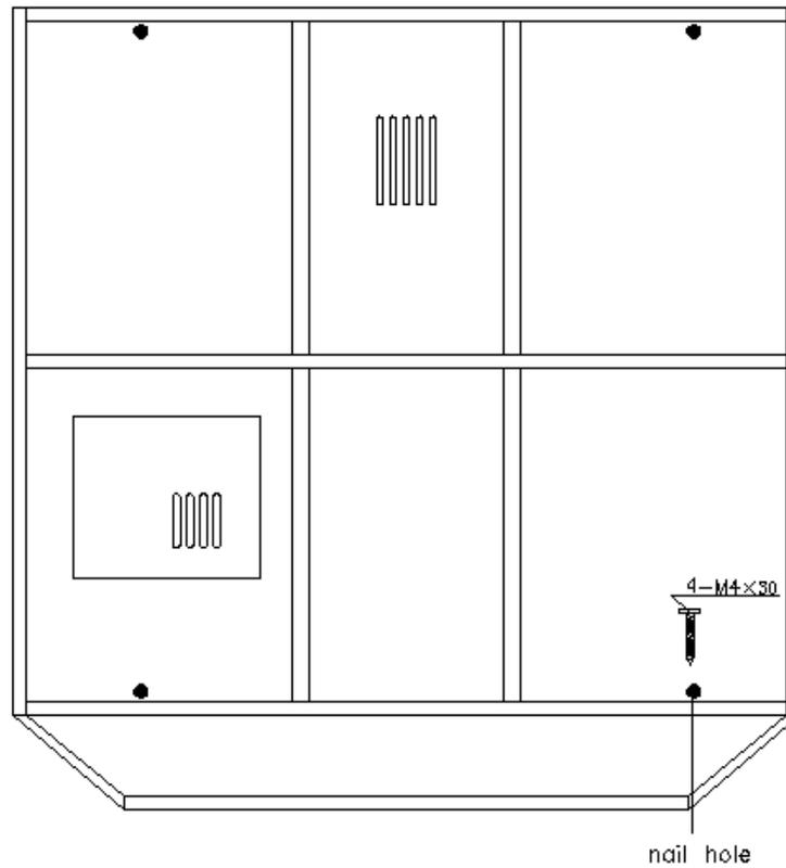
Montieren Sie die Staubschutzhaube mit Schrauben auf dem Dach
