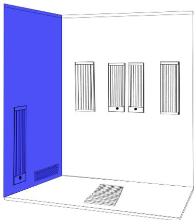
(3) Stellen Sie die linke Wand auf die Bodenplatte und verbinden Sie sie ordnungsgemäß mit den voreingestellten äußeren Schnallen.
