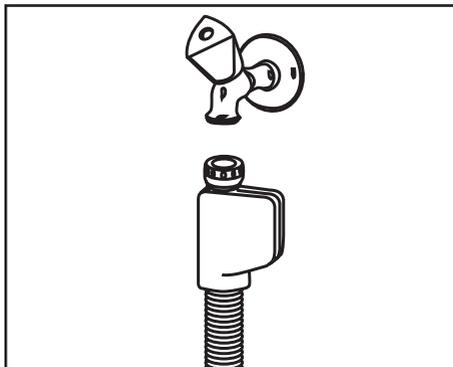
Darstellung 4.4: Wasserzulaufschlauchanschluss
