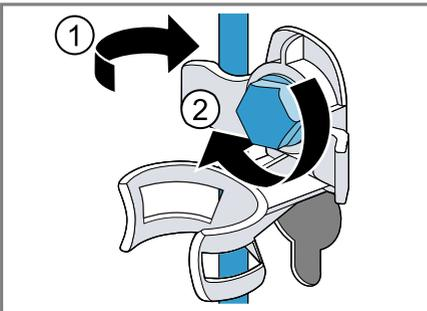
5. Den Schlauch in die Halterung einsetzen.
