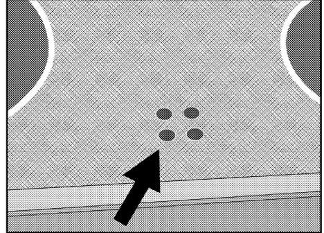
Die Warnanzeige für die heiße Zone zeigt die Position des eingeschalteten Kochfelds an und leuchtet nach dem Ausschalten weiter. Ein flackerndes Licht auf der Warnanzeige für die heiße Zone ist keine Fehlfunktion.
