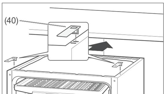
4. Stecken Sie beide Montagewinkel (40) in die vorderen Schlitze an der oberen Seite des Geräts, um später das Gerät an die Arbeitsplatte anschrauben zu können.
