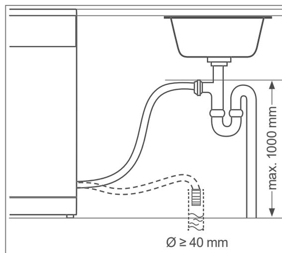
Sie können den Auslass des Ablaufschlauchs auf zwei verschiedene Weisen anschließen lassen:
