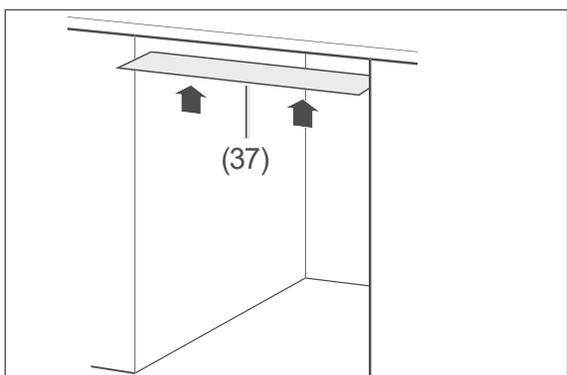
3. Kleben Sie die beiliegende Schutzfolie für Kondenswasser (37) auf die Unterseite der Arbeitsplatte. So vermeiden Sie Schäden an der Arbeitsplatte aufgrund heißer Dämpfe, die bei geöffneter Gerätetür aus dem Geschirrspüler strömen.
