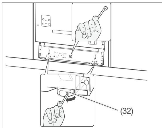
1. Stecken Sie einen Schraubendreher in einen der Schlitz, und drehen Sie die Stellfüße damit in die gewünschte Höhe.
