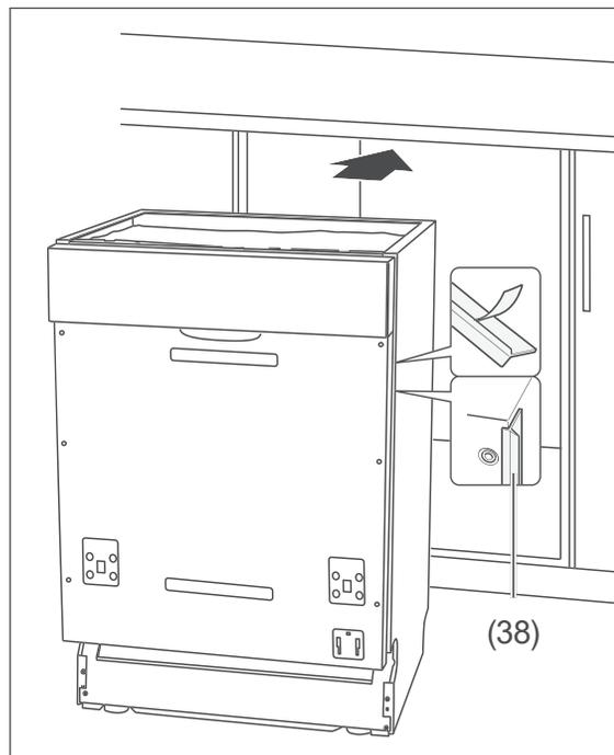
5. Entfernen Sie die Schutzfolien von den seitlichen Abschlussprofilen (38).
