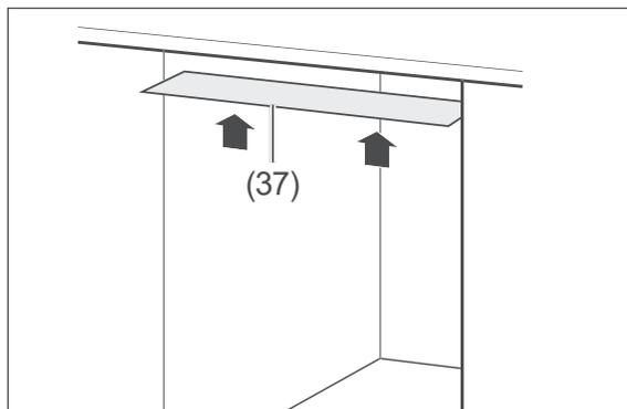
3. Kleben Sie die beiliegende Schutzfolie für Kondenswasser (37) auf die Unterseite der Arbeitsplatte. So vermeiden Sie Schäden an der Arbeitsplatte aufgrund heißer Dämpfe, die bei geöffneter Tür aus dem Gerät strömen.
