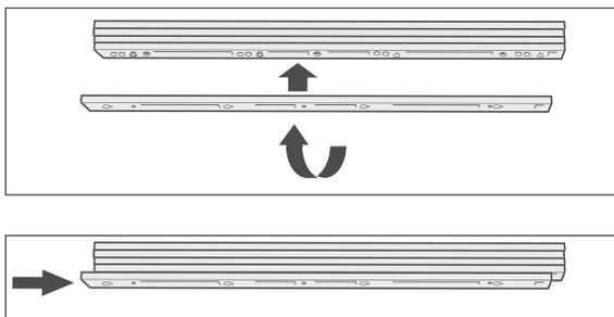
6. Wenn Sie mehr als 1 Zierleiste benötigen, drehen Sie die untere Zierleiste um und schieben Sie sie auf die übrigen. So verschwinden die „Füßchen“ und die Oberflächen sind plan.
