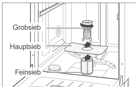
Überprüfen Sie nach jedem Spülgang das Grobsieb, das Hauptsieb und das Feinsieb, und entfernen Sie ggf. Speisereste und Fremdkörper:
