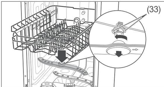
3. Der obere Sprüharm ist mit einem Bajonett-Verschluss befestigt. Zum Abnehmen des Sprüharms halten Sie die beiden gezackten Bajonettgriffe (33) fest, und drehen Sie den Sprüharm im Uhrzeigersinn ab.
