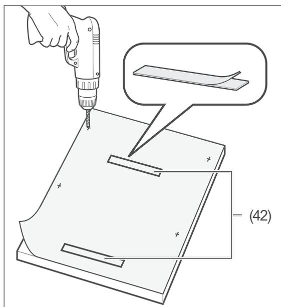
13. Legen Sie die mitgelieferte Bohrschablone so auf die Rückseite der Möbelfrontplatte, dass die Bohrschablone und die Möbelfrontplatte oben bündig abschließen.
