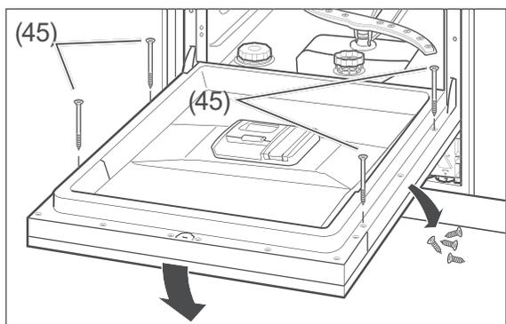
18. Entfernen Sie die 4 Schrauben an der Innenseite der Tür. Schrauben Sie die Möbelfrontplatte an diesen Positionen mithilfe der beiliegenden 4 Schrauben (45) fest.
