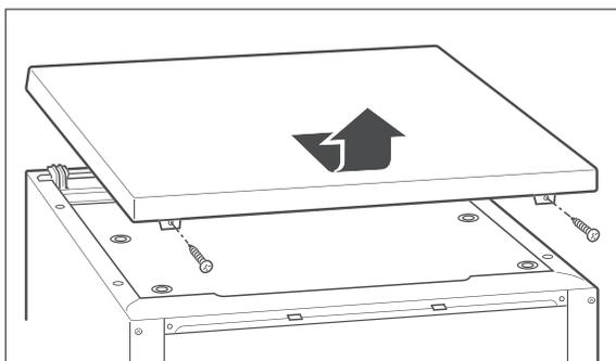
2. Lösen Sie die beiden Schrauben auf der Rückseite der Abdeckplatte und nehmen Sie diese ab.
