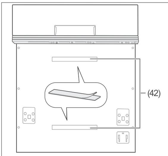
10. Kleben Sie die Klettbänder mit der abgezogenen Schutzfolie mittig auf die eingelassenen Bereiche auf der Gerätetür.
