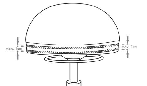
**D SCHLIESSVORGANG:** Bevor Sie den Reißverschluss schließen, sollte der Stoff gleichmäßig über das Luftkissen gezogen werden. Die obere und die untere Schließkette sollten dann ringsum möglichst nah aneinander liegen. Danach lässt sich der Reißverschluss leicht zuziehen.
