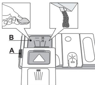
**Zum Öffnen des Spülmittelbehälters den Öffnungsmechanismus A drücken. Füllen Sie das Spülmittel ausschließlich in das trockene Fach B ein.**
