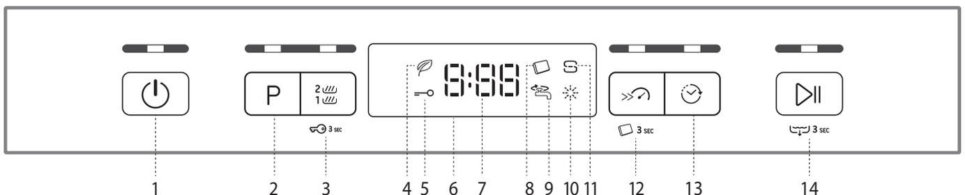
1. Ein-Aus/Reset Taste mit Anzeigelicht
