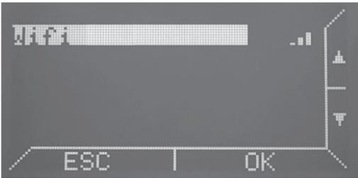
4. Geben Sie nun das Netzwerk-Passwort durch Betätigen der entsprechenden Tasten und Pfeile direkt in das BTOUCH Display ein. Bestätigen Sie das Passwort nach Eingabe des letzten Zeichens mit OK. Durch Drücken der INFO-Taste können Sie die Passwort-Eingabe sichtbar machen.
