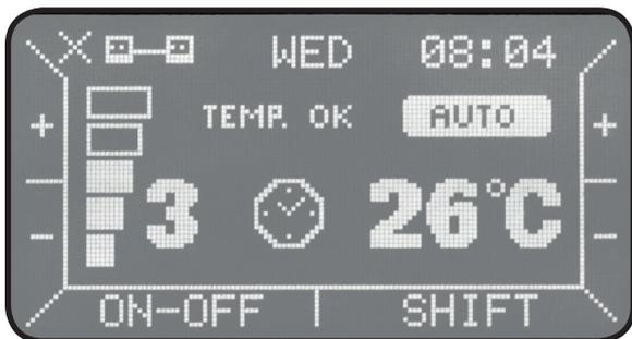
Abb. 13: Display-Anzeige bei Automatikbetrieb
