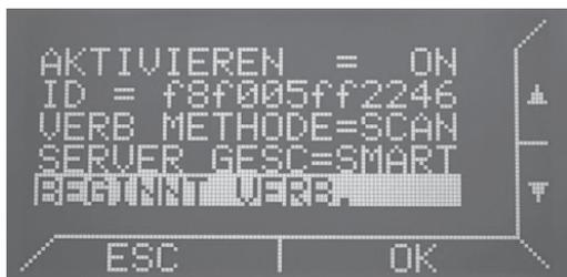
3. Nach dem Start des Verfahrens wird ein Scan der verfügbaren, drahtlosen Netzwerke erfolgen. Wählen Sie das gewünschte aus und bestätigen Sie mit OK.
