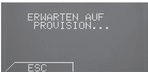
3. Suchen Sie nun zuerst nach einem verfügbaren WIFI Netzwerk. Überprüfen Sie ob ein Netzwerk „STOVE\_WIFI“ durch das Gerät erstellt wurde. Verbinden Sie sich mit diesem Netzwerk (**Netzwerksicherheit WAP, Passwort 1234567890**). Sobald Sie mit dem Netzwerk verbunden sind, öffnen Sie den Browser und drücken auf „Refresh“ oder geben die Adresse „stovewifi.com“ ein.
