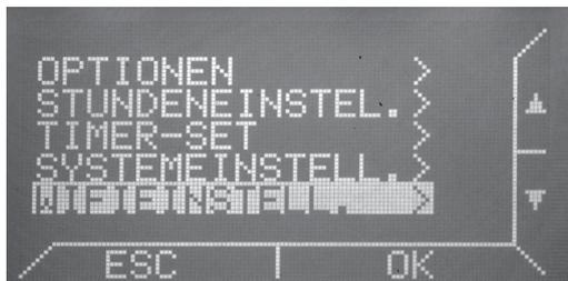
2. Zur Aktivierung der WIFI-Funktion wählen Sie **AKTIVIEREN = ON**. Hierfür Drücken sie die Taste OK. Die Werkseinstellung **OFF** beginnt zu blinken. Durch Drücken der Taste 6 wechselt der Modus zu **ON**. Bestätigen Sie mit **OK**. Danach erscheinen weitere Einstellungsmöglichkeiten der WIFI-Funktion auf dem Display. Notieren Sie an dieser Stelle die in Zeile 2 erscheinende ID. Die nicht veränderbare Ofen-Identifikationsnummer ist notwendig um die Bedienung über die App zu aktivieren.
