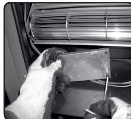
2. Entfernen Sie alle Schrauben (2 bzw. 4x) der Abdeckplatte mit einem Schraubenschlüssel (4 mm) wie in Abbildung 15b dargestellt.
