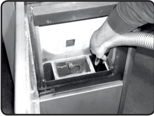
Abb. 14g: Reinigung untere Brennkammer
