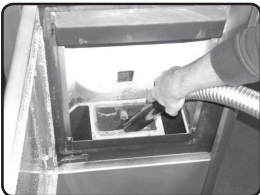
Abb. 14f: Reinigung Brennraumbehälter
