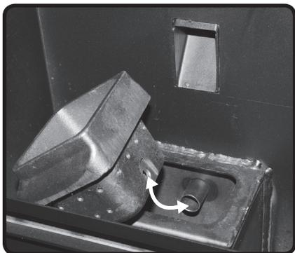
Abb. 8a: Brenntopf einsetzen
