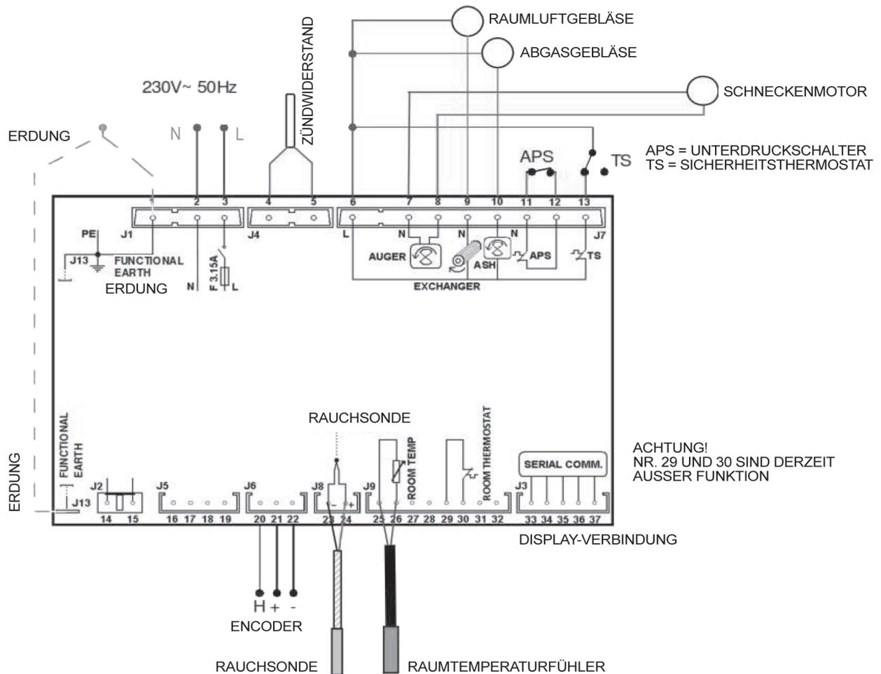
Abb. 16: Schaltplan der Platine
