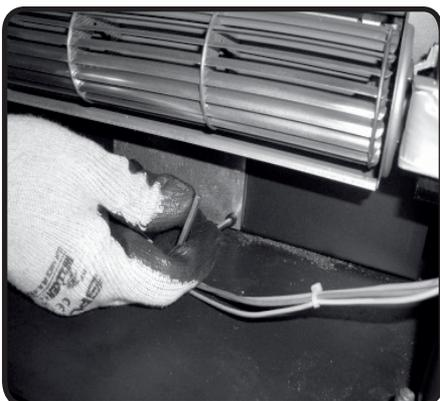
Abb. 15b: Aufschauben der inneren Abdeckplatte
