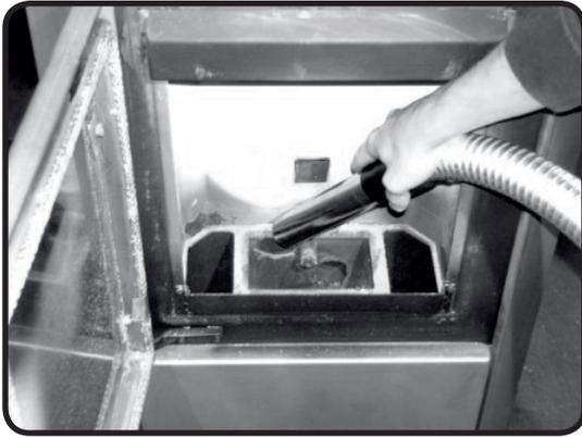
Abb. 14d: Reinigung der Topfhalterung
