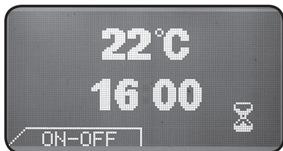
Abb. 9: Display-Anzeige während der Abkühlphase
