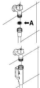
Der Geschirrspüler kann mit Wasser mit einer **Temperatur von nicht mehr als 60°C** gespeist werden. Speist man das Gerät mit warmem Wasser, verkürzt sich die Spülzeit um rund 20 Minuten, doch wird die Reinigungswirkung geringfügig reduziert. Der Anschluss erfolgt an das Warmwasserventil in der gleichen Weise, wie es für den Kaltwasseranschluss beschrieben wurde.
