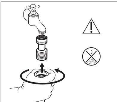
Bevor Sie die Maschine an neue Rohrleitungen oder an Rohrleitungen anschließen, die seit einiger Zeit nicht mehr verwendet wurden, lassen Sie eine angemessene Menge Wasser ab, um Schmutz zu entfernen, der sich in den Rohrleitungen angesammelt haben könnte.
