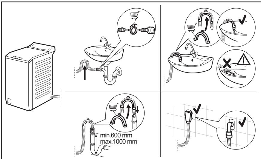
Der Ablaufschlauch muss in einer Höhe nicht unter 600 mm und nicht über 1000 mm angebracht werden.
