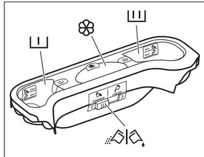
Waschmittelfach für die Vorwäsche. Die Markierungen MAX zeigen die maximalen Mengen an Waschmittel (Pulver oder Flüssigkeit) an. Beim Einstellen eines Fleckenprogramms geben Sie das entsprechende Waschmittel (in Pulverform oder flüssig) hinzu.
