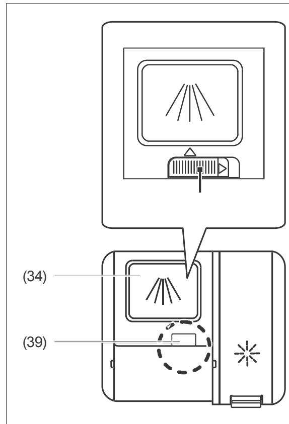
1. Schieben Sie den Verschluss (39) der Spülmittelkammer (34) zur Seite. Der Deckel springt auf.
