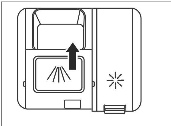
4. Drücken Sie den Deckel der Kammer zu, sodass der Verschluss (39) wieder einrastet.
