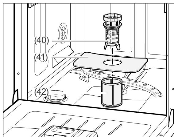
Überprüfen Sie nach jedem Spülgang das Grobsieb (40), das Hauptsieb (41) und das Feinsieb (42), und entfernen Sie ggf. Speisereste und Fremdkörper:
