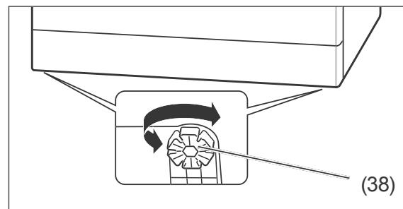
2. Um Unebenheiten des Bodens auszugleichen und den Geschirrspüler waagerecht auszurichten, können Sie die zwei Stellfüße (38) heraus- oder hineindrehen. Die Stellfüße haben ringsherum Schlitze. Stecken Sie hier einen Schraubendreher hinein und drehen Sie damit den Stellfuß. Verwenden Sie zum Ausrichten des Geschirrspülers eine Wasserwaage.
