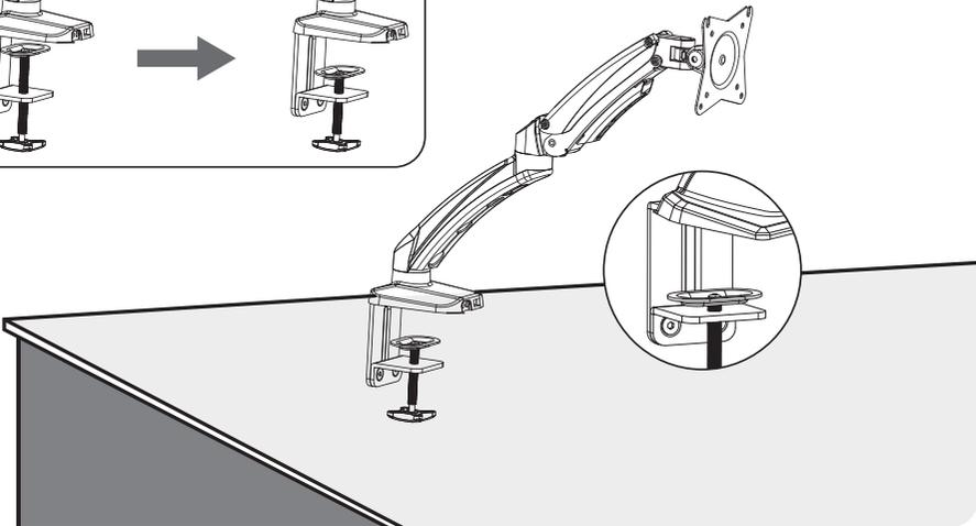
Die Klemme mit der Klemmschraube anziehen, bis die Halterung sicher am Tisch befestigt ist.
