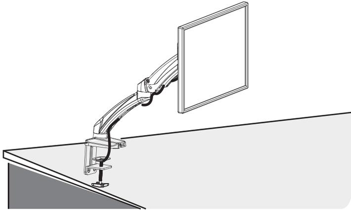
**Kabel in Kabelabdeckungen einführen. Die Kabel an den Armgelenken für die vollständige Einstellung locker hängen lassen.**
