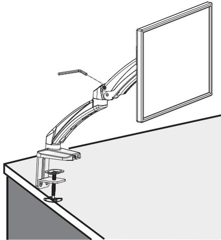
Einen Sechskantschlüssel zur Einstellung der Höhenspannung des Gasfederarms verwenden, damit unterschiedlich schwere Monitore in jeder Position ruhig gehalten werden.
