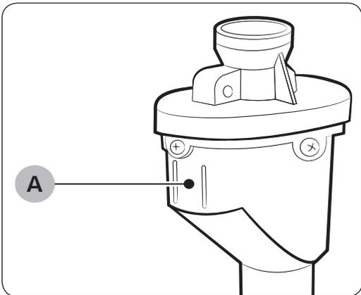
Der AquaStop-Schlauch warnt den Benutzer vor der Gefahr eines Wasseraustritts. Er misst den Wasserdurchfluss, und im Falle eines Lecks wechselt die **Anzeige (A)** in der Mitte des AquaStop-Schlauchs ihre Farbe zu rot.
