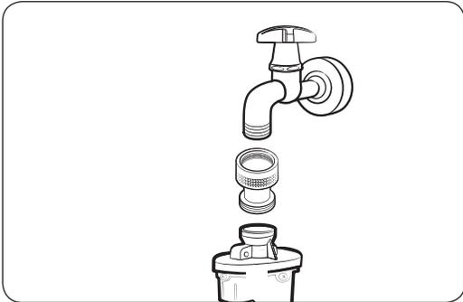
Bevor Sie den Wasserschlauch an einen Wasserhahn anschließen, müssen Sie das mitgelieferte Rückschlagventil an den Wasserhahn anschließen und dürften erst dann den Wasserschlauch anschließen.
