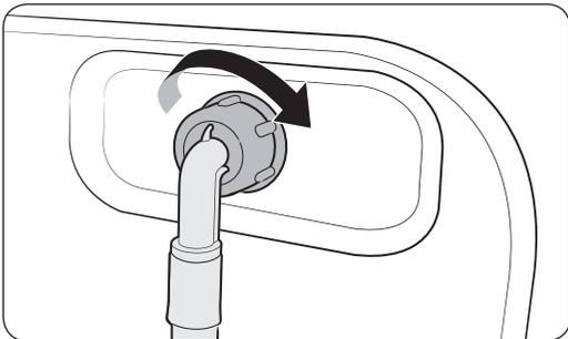
2. Schließen Sie das andere Ende des Frischwasserschlauchs an das Wassereinlaufventil auf der Rückseite der Waschmaschine an und drehen Sie den Überwurfring dann nach rechts fest.
