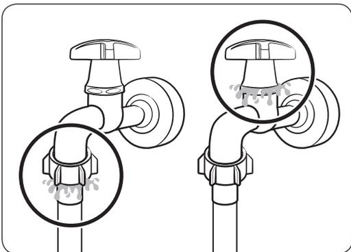
3. Öffnen Sie den Wasserhahn, und überprüfen Sie die Anschlüsse dann auf Lecks. Sollte tatsächlich Wasser austreten, müssen Sie die Schritte 1 und 2 wiederholen.
