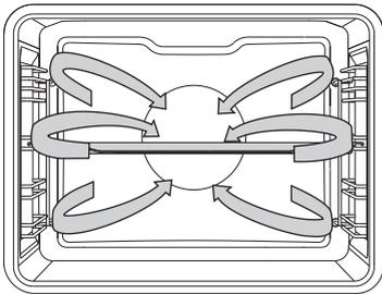
Gleichzeitig sind der Ringheizkörper und das Gebläse in Betrieb. Das Gebläse an der Rückwand des Garraums sorgt für ständiges Kreisen der heißen Luft um das Back-/Bratgut.
