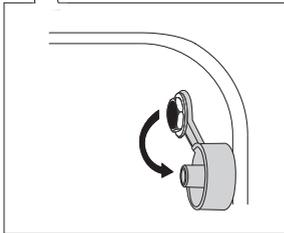
**1** Entfernen Sie den Metallstopfen (die Steckdose befindet sich in der vorderen oberen Ecke der rechten Seite des Garraums).
