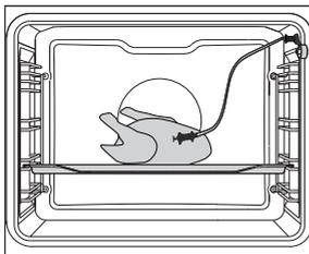
**2** Stecken Sie den Stecker der Fleischsonde in die Steckdose im Garraum und stechen Sie die Sonde in das Fleischstück. (Falls Sie vorher eine Zeitfunktion eingestellt haben, wird diese gelöscht).
