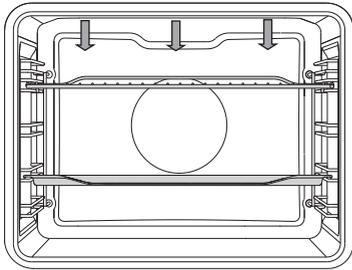
Bei der Betriebsart Großflächengrill sind die Oberhitze und das an der Garraumdecke angebrachte Infrarot-Heizelement in Betrieb.
