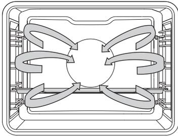
Gleichzeitig sind der Ringheizkörper und das Gebläse in Betrieb. Das Gebläse an der Rückwand des Garraums sorgt für ständiges Kreisen der heißen Luft um das Brat-/Backgut.
