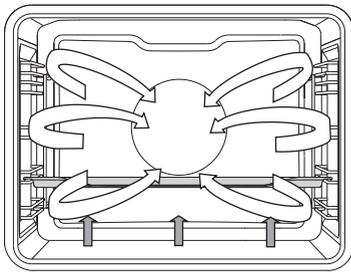
Diese Betriebsart ist vor allem zum Backen von niedrigem Backgut und Einkochen von Obst und Gemüse geeignet. Verwenden Sie die 2. Einschubebene von unten und nicht allzu hohe Backbleche, damit die erhitzte Luft auch auf der Oberseite des Backguts kreisen kann.
