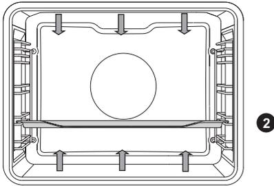
Die im Ober- und Unterteil des Garraums eingebauten Heizelemente strahlen die Hitze gleichmäßig in den Garraum.
