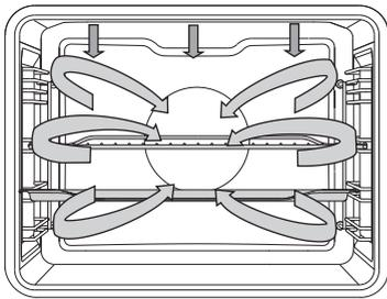
Beim automatischen Braten ist die Oberhitze in Kombination mit dem Infrarot-Heizelement und dem Ringheizkörper in Betrieb. Diese Einstellung wird für alle Arten von Fleisch verwendet.
