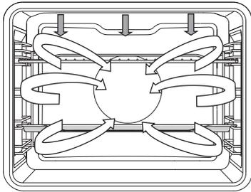
Bei dieser Betriebsart sind gleichzeitig das Infrarot-Heizelement und das Gebläse in Betrieb. Sie ist zum Braten von Fleisch, Fisch und Gemüse geeignet.
