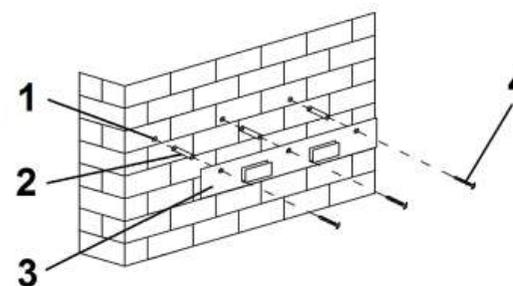
1. Bohrlöcher ( $\varnothing 8$  mm)
