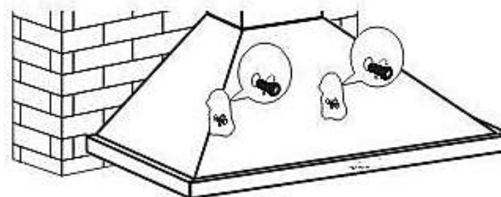
(3) Heben Sie die Dunstabzugshaube an und hängen Sie sie an die Wandhalterung (s. Abb. unten). Befestigen Sie die Dunstabzugshaube, indem Sie die Schrauben ordnungsgemäß festziehen.
