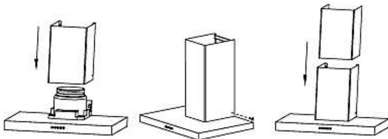
(9) Richten Sie die Kaminteile entsprechend der Abmessungen des Haltebügels aus (s. Abb. unten).
