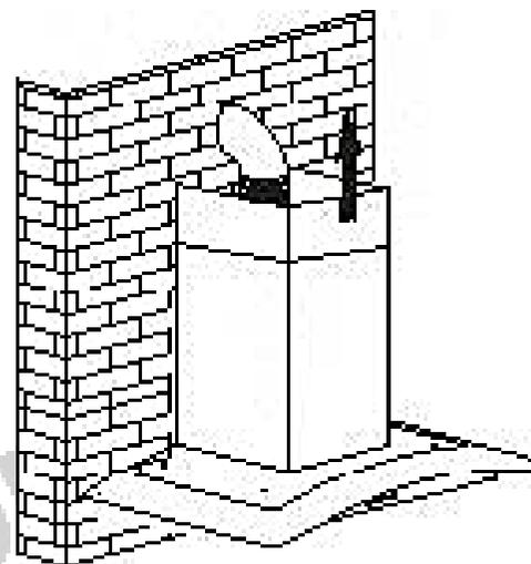
(7) Setzen Sie den inneren Kamin in den äußeren ein (s. Abb. unten).
