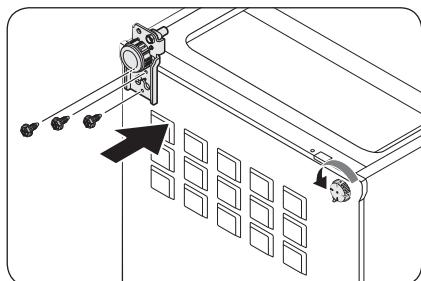
1. Allongez au sol le réfrigérateur avec précaution. Ensuite, retirez les vis au niveau de la charnière inférieure sur le côté droit et le **pied de mise à niveau** sur le côté gauche, respectivement.
