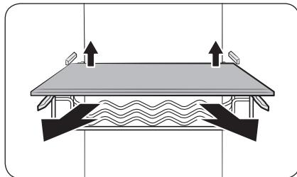
Heben Sie den Fachboden zum Herausziehen leicht am hinteren Ende an.
