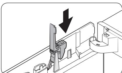
6. Setzen Sie die **Dongle-Abdeckung** wieder an der ursprünglichen Stelle ein.
