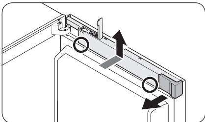
1. Öffnen Sie die **Dongle-Abdeckung** und entfernen Sie die **Raumabdeckung**.
