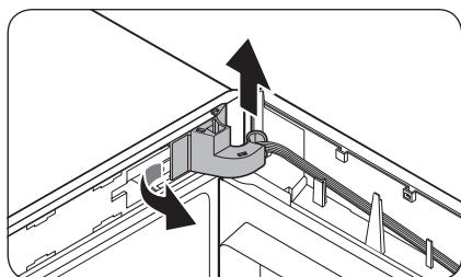
2. Trek de linkerkant van de scharnierkap naar links om deze te verwijderen, en til vervolgens de onderkant een beetje omhoog om de kap te verwijderen.
