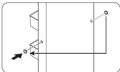
3. Gebruik de platte schroevendraaier om de schroefkappen van de handgreet (2x) te verwijderen. Steek de schroefkappen van de handgreet in de andere kant.
