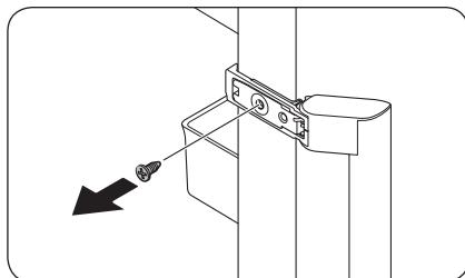
2. Entfernen Sie die Schrauben oben und unten am Griff.
