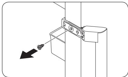
2. Verwijder alle schroeven van de boven- en onderkant van de handgreet.
