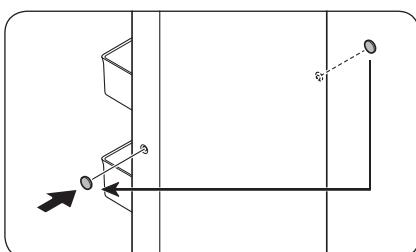
3. Utilisez un tournevis à tête plate pour retirer les obturateurs des vis de la poignée (x2).
