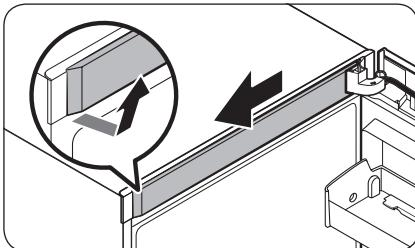
1. Entfernen Sie zunächst die **obere Rahmenabdeckung** von der rechten Seite. Ziehen Sie sie dann nach vorn heraus.
