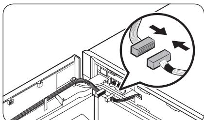
7. Sluit de aansluitingen van de vriezerdeur en de hoofdeenheid aan. Zet vervolgens de bedrading vast aan de binnenhaak van de optionele scharnierkap (L).
