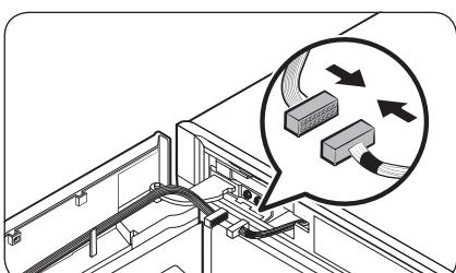
7. Schließen Sie die Anschlüsse an der Tür des Gefrierabteils und am Hauptgerät an. Befestigen Sie dann die Kabel auf dem Innenhaken der optionalen Scharnierabdeckung (L).
