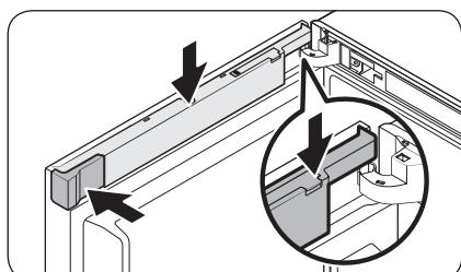
10. Insérez le cache des câbles à travers le cache de la clé électronique qui est ouvert. Tournez le cache de 90 degrés vers l'avant, puis poussez-le vers le bas pour le mettre en place.
