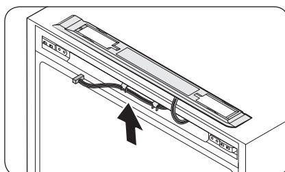
2. Déplacez les connecteurs et les câbles sur le côté opposé. Insérez le **cache des commandes**, puis serrez les vis sur le côté opposé.
