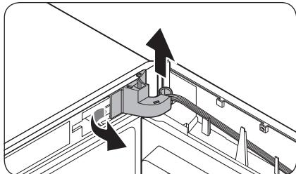
2. Trek de linkerkant van de scharnierkap naar links om deze te verwijderen, en til vervolgens de onderkant een beetje omhoog om de kap te verwijderen.
