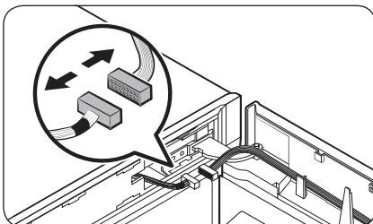
3. Trennen Sie die Anschlüsse im Bereich der Tür des Gefrierabteils. Lösen Sie die Schrauben am **oberen Scharnier**, um es zu entfernen.
