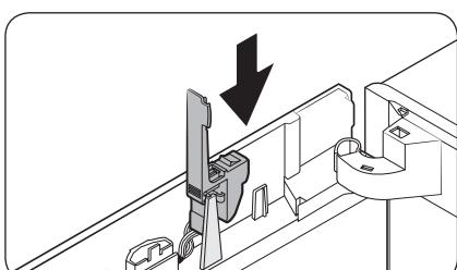
6. Plaats de **dongle-afdekking** terug op zijn oorspronkelijke plaats.
