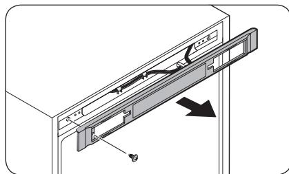
1. Verwijder de schroef en vervolgens de bedieningspaneelafdekking.
