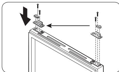
1. Entfernen Sie den **Hebel der Türschließautomatik** von der Tür des Gefrierabteils. Lösen Sie dazu die Schrauben am Hebel und auf der gegenüberliegenden Seite.
