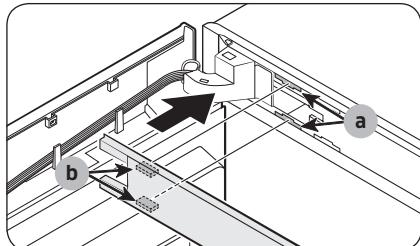
9. Plaats de afdekking van het bovenframe terug, waarbij onderdeel (b) diagonaal in onderdeel (a) past.
