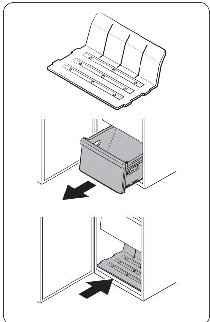
Als u meer opslagruimte nodig hebt, kunt u het deksel van de bovenste plank en de 4 laden verwijderen en de meegeleverde bodemplaat (zie afbeelding) onder in de hoofdeenheid plaatsen. Verwijder vervolgens de IJsblokjesmaker.
