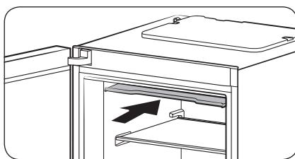
2. Drücken Sie die Klappe dann bis zum hinteren Anschlag nach innen.
