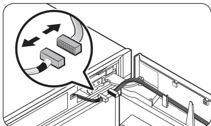
3. Koppel de aansluitingen los op rond de vriezerdeur. Maak de schroeven van het bovenste scharnier los om dit te verwijderen.
