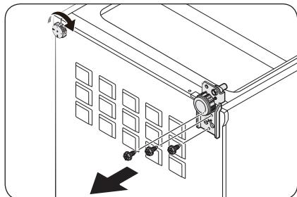
1. Legen Sie die Kühl-/Gefrierkombination vorsichtig auf den Boden. Entfernen Sie anschließend die Schrauben am **unteren Scharnier** auf der rechten Seite und den **Justierfuß** auf der linken Seite.
