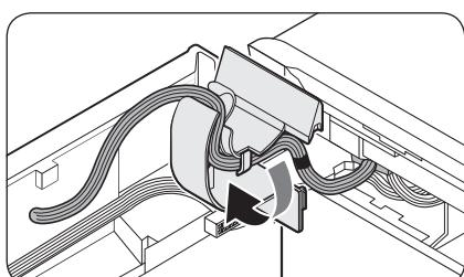
8. Plaats de **scharnierkap** op het **bovenste scharnier**, rechts eerst. Druk vervolgens op de onderkant van de kap om deze vast te zetten.
