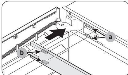
9. Insérez le cache du cadre supérieur avec la pièce (b) insérée dans la pièce (a), en diagonale.
