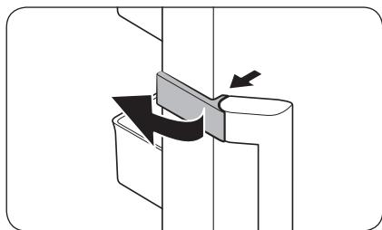
1. Ontgrendel de afdekking van de handgreet en leg deze apart.
