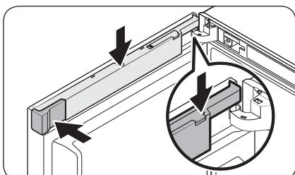
10. Plaats de kabelkap door de geopende dongle-afdekking. Draai de kap 90 graden naar voren en druk hem naar beneden vast.
