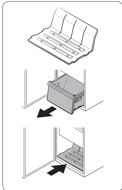
Wenn Sie mehr Stauraum benötigen, entfernen Sie die obere Fachbodenklappe sowie alle vier Schubfächer und setzen Sie den mitgelieferten Fachboden (siehe Abbildung) unten in der Haupteinheit ein. Entfernen Sie dann die schmale Eismaschine.
