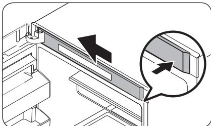
8. Insérez le cache de charnière sur la charnière supérieure, en commençant par le côté droit. Ensuite, pressez le bas du cache pour le mettre en place.
