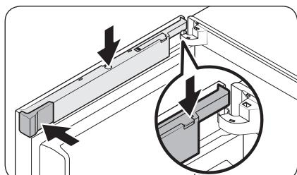
10. Setzen Sie die Kabelabdeckung durch die geöffnete Dongle-Abdeckung hindurch ein. Drehen Sie die Abdeckung um 90 Grad nach vorne und drücken Sie sie dann nach unten drücken, um sie einzurasten.
