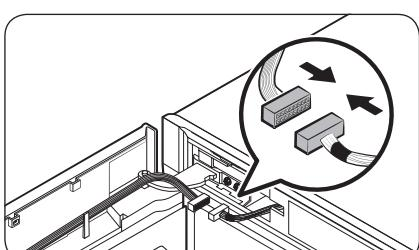
7. Sluit de aansluitingen van de vriezerdeur en de hoofdeenheid aan. Zet vervolgens de bedrading vast aan de binnenhaak van de optionele scharnierkap (L).
