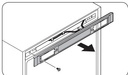
1. Entfernen Sie die Schraube und ziehen Sie die Abdeckleiste heraus.
