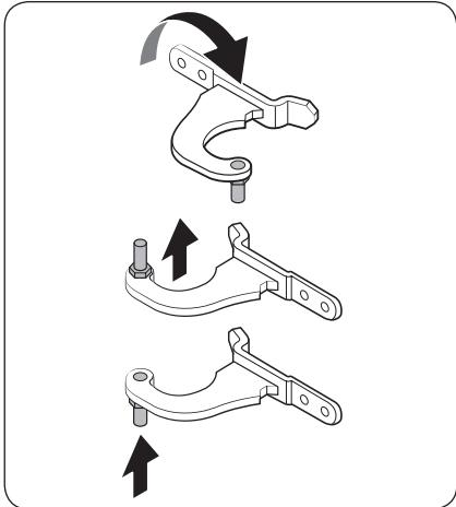
3. Entfernen Sie den **Bolzen** vom **oberen Scharnier**. Setzen Sie dann den Bolzen wie dargestellt wieder ein.
