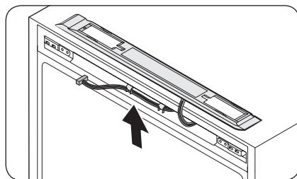
2. Verplaats de aansluitingen en bedrading naar de andere kant. Plaats de bedieningspaneelafdekking en draai de schroeven aan de andere kant aan.
