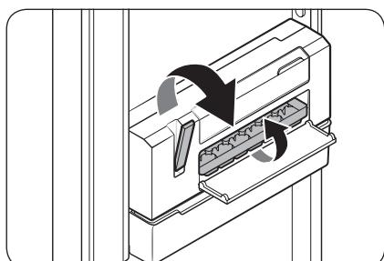
2. Vérifiez si les glaçons gèlent complètement. Une fois que les glaçons ont complètement gelé, tirez le **levier distributeur de la machine à glaçons** (02) vers le haut. Ensuite, le **générateur de glaçons** (04) tourne et verse des glaçons dans le **bac à glaçons** (03).
