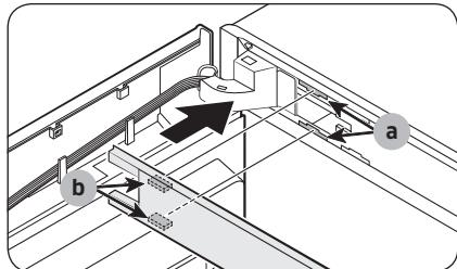
9. Stecken Sie die obere Rahmenabdeckung mit Teil (b) diagonal in Teil (a).
