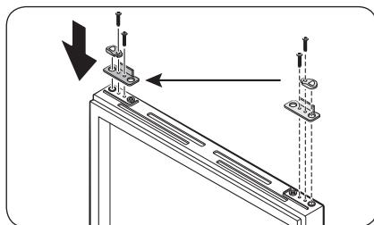
1. Verwijder de hendel van de automatische sluiting op de vriezerdeur door de schroeven los te draaien op de hendel en aan de andere kant ervan.
