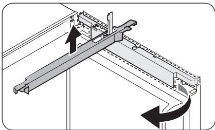
3. Drehen Sie die **Kabelabdeckung** um 90 Grad nach vorne und drücken Sie sie dann nach oben, um sie entfernen.
