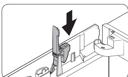
6. Réinsérez le cache de la clé électronique dans sa position d'origine.
