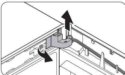
2. Lösen Sie durch Ziehen die linke Seite der **Scharnierabdeckung** und heben Sie dann den unteren Teil leicht an, um sie herauszuziehen.
