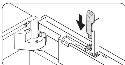
2. Insérez la clé électronique Smart Home Dongle dans le port de clé électronique dans le bon sens.
