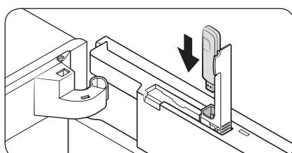
2. Stecken Sie den Smart Home Dongle in der richtigen Orientierung in die Dongle-Buchse
