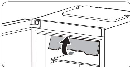
1. Ziehen Sie das vordere Ende der oberen Fachbodenklappe ganz nach oben.
