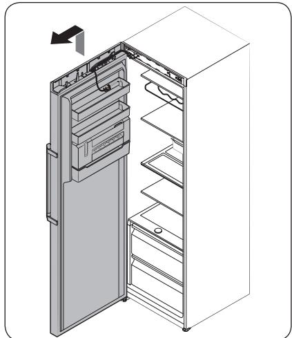
4. Wenn das obere Scharnier ausgebaut ist, heben Sie die Tür des Gefrierabteils nach oben heraus. Bewahren Sie die Tür sicher auf.
