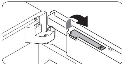
1. Öffnen Sie die Tür des Gefrierabteils und ziehen Sie die Dongle-Abdeckung oben an der Tür zum Öffnen nach oben.
