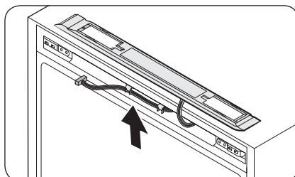
2. Verlegen Sie die Anschlüsse und Leitungen an die gegenüberliegende Seite. Setzen Sie die Abdeckleiste an und ziehen Sie die Schrauben auf der gegenüberliegenden Seite fest.
