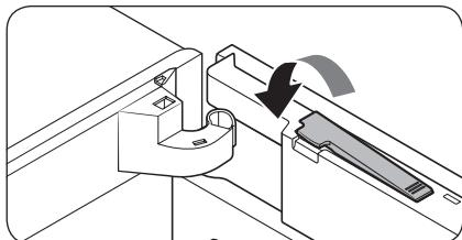
3. Druk omlaag om de dongle-afdekking te sluiten.
