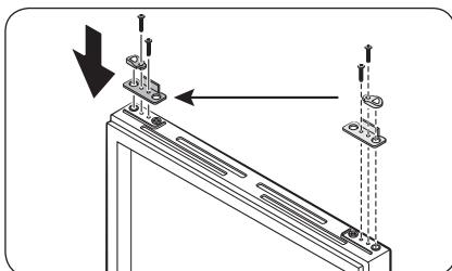
1. Sur la porte du congélateur, retirez le levier du système de fermeture automatique en desserrant les vis sur le levier et les vis sur le côté opposé.
