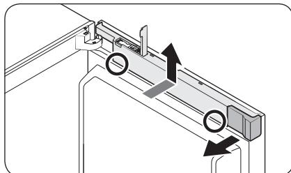
1. Open de dongle-afdekking en verwijder de tussenstukafdekking.
