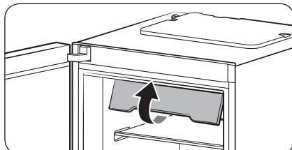
1. Til de voorkant van het deksel van de bovenste plank helemaal op.
