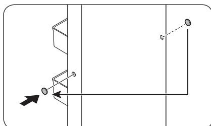
3. Entfernen Sie mit einem Schlitzschraubendreher die **Schraubenabdeckungen des Griffes**. Setzen Sie dann die **Schraubenabdeckungen des Griffes** auf der gegenüberliegenden Seite wieder auf.
