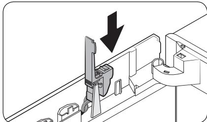
6. Plaats de **dongle-afdekking** terug op zijn oorspronkelijke plaats.
