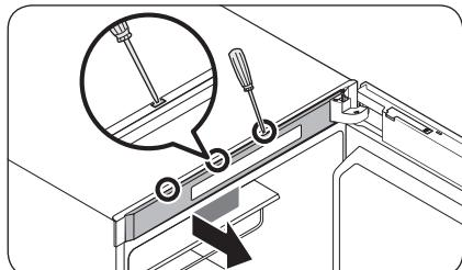
1. Lösen Sie die Befestigungen der **oberen Rahmenabdeckung** mit Hilfe eines Schlitzschraubendrehers der Reihe nach aus den Bohrungen oben an der Tür, um die Abdeckung abzunehmen.
