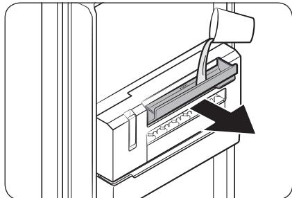
1. Tirez la poignée du bac à eau (01) vers le haut pour l'ouvrir, puis remplissez le bac d'eau jusqu'à la ligne de niveau maximum. Fermez doucement le bac de sorte de ne pas provoquer de gouttes ou de fuites d'eau.
