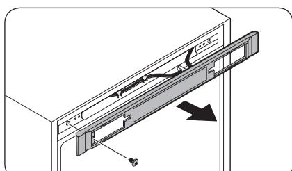
1. Verwijder de schroef en vervolgens de bedieningspaneelafdekking.
