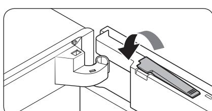
3. Drücken Sie die Dongle-Abdeckung zum Schließen herunter.
