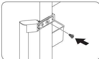
1. Setzen Sie den Griff auf der entgegengesetzten Seite ein und ziehen Sie die Schraube fest.
