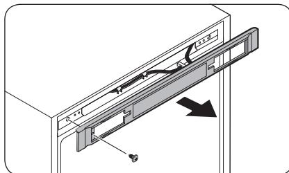
1. Entfernen Sie die Schraube und ziehen Sie die Abdeckleiste heraus.
