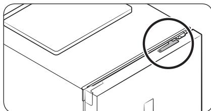
Mithilfe des Smart Home Dongle, der separat verkauft wird, können Sie die Kühl-/Gefrierkombination per Fernzugriff steuern. Wenn Sie einen Smart Home Dongle kaufen möchten, richten Sie sich nach den Produktinformationen auf [www.samsung.com](http://www.samsung.com).
