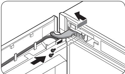
4. Setzen Sie zunächst das untere Ende der Tür wieder in den Gerätekörper ein.
