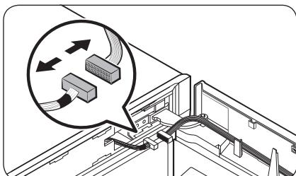
3. Débranchez les connecteurs situés sur ou autour de la porte du congélateur. Desserrez les vis au niveau de la **charnière supérieure** pour la retirer.
