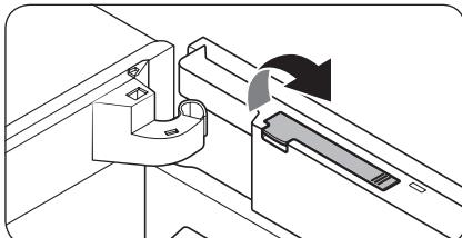
1. Open de deur van de vriezer en trek omhoog om de dongle-afdekking boven in de deur te openen.
