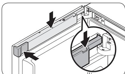
10. Setzen Sie die Kabelabdeckung durch die geöffnete Dongle-Abdeckung hindurch ein. Drehen Sie die Abdeckung um 90 Grad nach vorne und drücken Sie sie dann nach unten drücken, um sie einzurasten.
