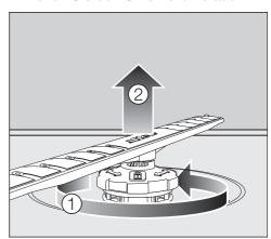
■ Drehen Sie die Verschraubung des unteren Sprüharms gegen den Uhrzeigersinn ① und ziehen Sie den Sprüharm nach oben ab ②.
