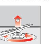
■ Drehen Sie die Verschraubung des unteren Sprüharms gegen den Uhrzeigersinn 1 und ziehen Sie den Sprüharm nach oben ab 2.
