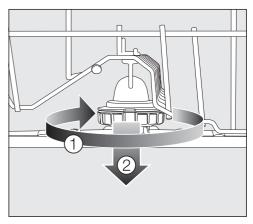
■ Drehen Sie die Verschraubung des mittleren Sprüharms im Uhrzeigersinn ① (siehe Abbildung) und nehmen Sie den Sprüharm ab ②.
