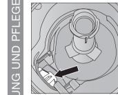
Unter der Abdeckung befindet sich die Ablaufpumpe (Pfeil).
