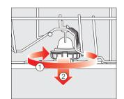
■ Drehen Sie die Verschraubung des mittleren Sprüharms im Uhrzeigersinn (1) (siehe Abbildung) und nehmen Sie den Sprüharm ab (2).
