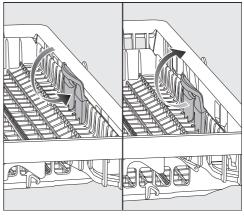
Ziehen Sie den Einsatz an dem gelben Griff nach innen und lassen Sie den Einsatz in einer der beiden Positionen einrasten.
