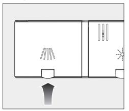
■ Heben Sie die gelbe Taste am Deckel des Reinigerfachs ///\/\\\ an.
