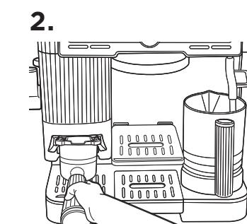
Den Hebel loslassen und den Siebträger aus der Mahlwerkhalterung nehmen.
