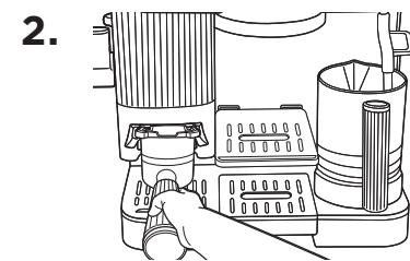
Insérez le porte-filtre dans le support de broyage. Vérifier qu'il est bien droit et bien ajusté. Une fois le porte-filtre installé dans le support de broyage, il sera pesé. Pour une pesée plus précise, ne pas tenir le porte-filtre.
