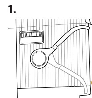
Nach dem Mahlen den Hebel des integrierten Tamper bis zum Anschlag fest nach unten drücken. Beim Verdichten des Pucks werden Sie einen gewissen Widerstand spüren. Den Hebel loslassen und den Vorgang für einen zweiten Vorgang wiederholen.
