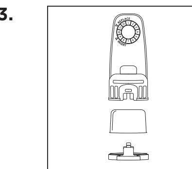
Retirez l'embout du boîtier du filtre et insérez le filtre. Replacez l'embout sur le boîtier du filtre pour bloquer le filtre en place.
