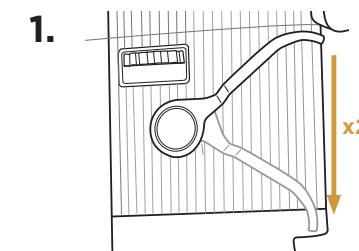
Nach dem Mahlen den Hebel des integrierten Tamper bis zum Anschlag fest nach unten drücken. Beim Verdichten des Pucks werden Sie einen gewissen Widerstand spüren. Den Hebel loslassen und den Vorgang für einen zweiten Vorgang wiederholen.
