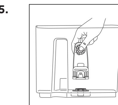
Installez le boîtier du filtre dans le réservoir.
