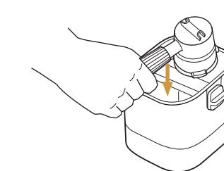
Une fois la préparation terminée, la machine émet un nouveau signal sonore. Retirez délicatement le porte-filtre de la tête du groupe. Jetez le marc de café en tapotant la surface du panier au-dessus d'un récipient ou du bac à marc\*. ATTENTION, CAR LE PORTE-FILTRE RISQUE D'ÊTRE CHAUD.
