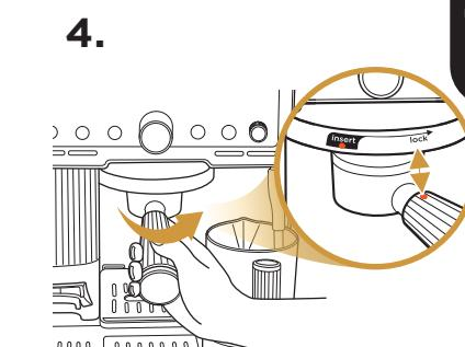
Befestigen Sie den Siebträger so, dass er auf den Sicherungspfeil ausgerichtet ist.
