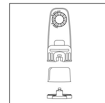
Die Endkappe vom Filtergehäuse entfernen und den Filter einsetzen. Die Endkappe wieder auf das Filtergehäuse aufstecken, um den Filter zu fixieren.
