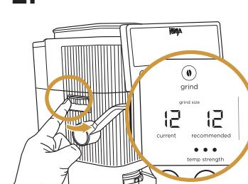
S'ils ne correspondent pas, ajustez la taille de la mouture actuelle en faisant tourner le bouton de mouture sur le côté gauche de l'appareil, jusqu'à ce qu'elle corresponde au réglage recommandé.
