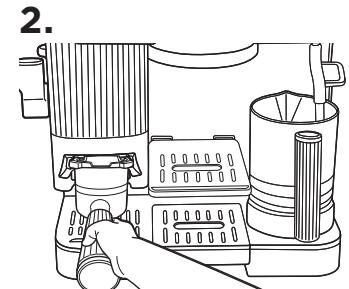
Den Siebträger in die Mahlwerkhalterung einsetzen. Achten Sie darauf, dass er gerade ist und sicher sitzt.
