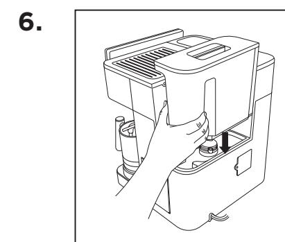
Remettez le réservoir d'eau dans la machine.
