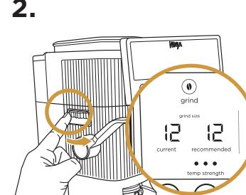
Wenn sie nicht übereinstimmen, **muss der aktuelle Mahlgrad angepasst werden, indem der Mahlgradregler auf der linken Seite der Maschine** auf die empfohlene Einstellung gedreht wird.
