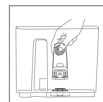
Das Filtergehäuse in den Behälter einsetzen.
