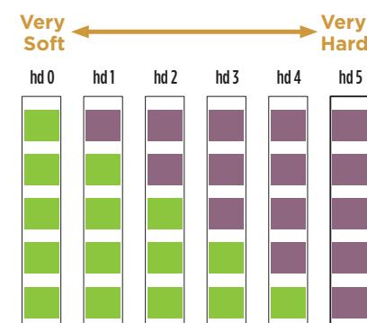
Es werden 0-5 lila Quadrate angezeigt. Dies zeigt den Wasserhärtegrad des Wassers an (0 lila Quadrate = Stufe 0, 5 lila Quadrate = Stufe 5 usw.).
