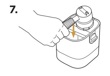
Nach Abschluss des Vorgangs ertönt erneut ein Signalton, der anzeigt, dass der Brühvorgang abgeschlossen ist. Entnehmen Sie die Tasse und dann vorsichtig den Siebträger aus dem Gruppenkopf. Entsorgen Sie das Mahlgut, indem Sie über einem Behälter oder einer Knockbox\* gegen die Oberfläche des Baskets klopfen.
