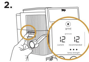
Wenn sie nicht übereinstimmen, **muss der aktuelle Mahlgrad angepasst werden, indem der Mahlgradregler auf der linken Seite der Maschine** auf die empfohlene Einstellung gedreht wird.
