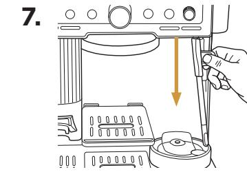
Drücken Sie die Dampfdüse nach unten. Die Maschine spült die Düse nach jedem Gebrauch automatisch, um die Dampfdüse von innen zu reinigen.
