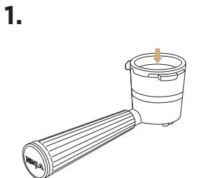
Den Siebträger überprüfen und darauf achten, dass der Double Basket eingesetzt ist.\*
