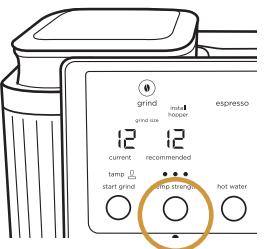
**Maintenez le bouton TEMP STRENGTH (TEMPÉRATURE INTENSITÉ) enfoncé pendant 3 secondes** pour passer de la température à l'intensité.
