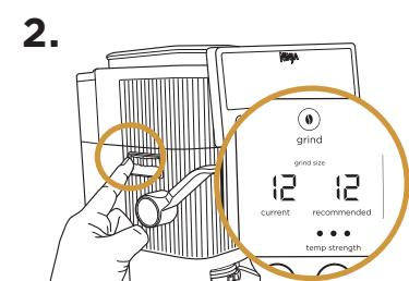
S'ils ne correspondent pas, ajustez la taille de la mouture actuelle en faisant tourner le bouton de mouture sur le côté gauche de l'appareil, jusqu'à ce qu'elle corresponde au réglage recommandé.
