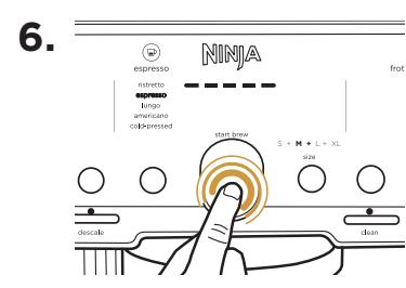
Appuyez sur START BREW (DÉMARRER L'INFUSION). La machine émet un signal sonore pour indiquer que l'infusion démarre. La barre de progression s'allume pour indiquer l'état d'avancement de la préparation.
