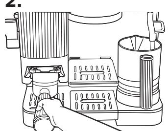
Insérez le porte-filtre dans le support de broyage. Vérifier qu'il est bien droit et bien ajusté. Une fois le porte-filtre installé dans le support de broyage, il sera pesé. Pour une pesée plus précise, ne pas tenir le porte-filtre.
