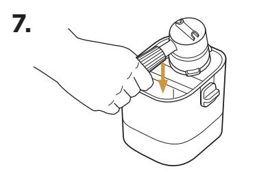
Une fois la préparation terminée, la machine émet un nouveau signal sonore. Retirez délicatement le porte-filtre de la tête du groupe. Jetez le marc de café en tapotant la surface du panier au-dessus d'un récipient ou du bac à marc.\*
