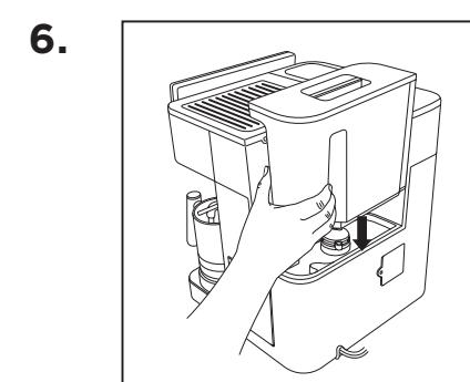
Wasserbehälter wieder in die Maschine einsetzen.
