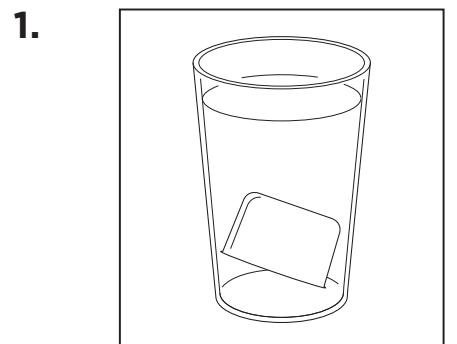
Den Wasserfilter 5 Minuten in Wasser einweichen lassen.
