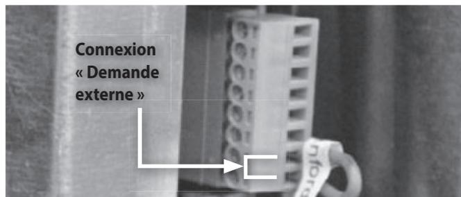
L'**électronique de commande** apparaît. Le branchement se fait sur le bornier correspondant.
