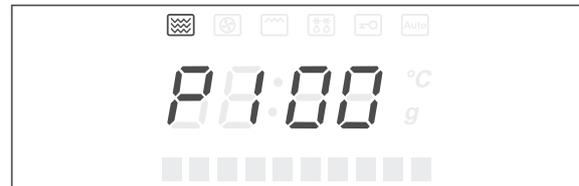
Auf dem Display (2) leuchtet die Anzeige
