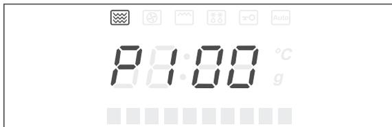
Auf dem Display (2) leuchtet die Anzeige
