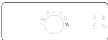
2. Stellen Sie den Moduswähler auf die Position für die Dampfreinigung.
