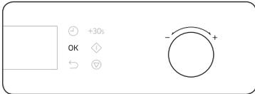
Stellen Sie durch Drehen am Funktionswähler die Standardleistung ein. Drücken Sie anschließend **OK**, um mit dem nächsten Schritt fortzufahren.
