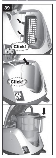
Setzen Sie die neue Filtereinheit wieder in das Gerät ein und lassen Sie die Verschlusslaschen hörbar einrasten.
