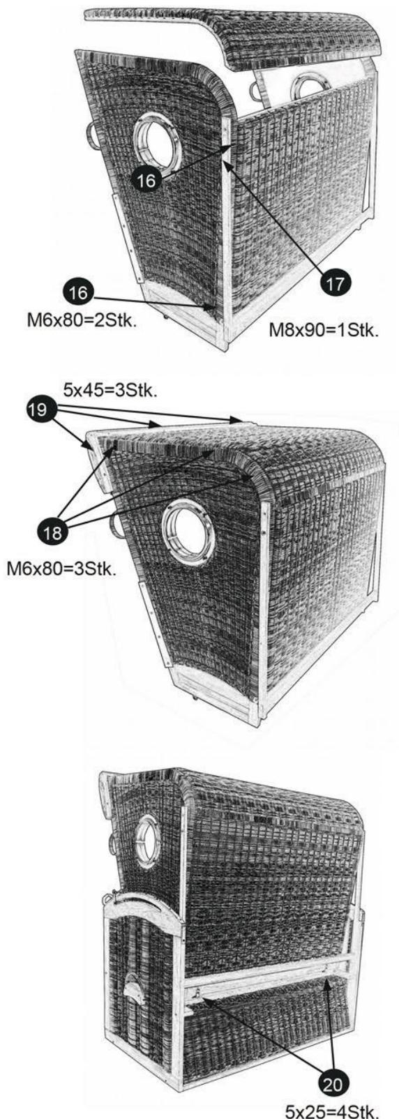
**16.** Verschrauben Sie die Seiten und die Rückwand mit je 2 Gewindebolzen M6 x 80 mm. Ziehen Sie alle Bolzen vorerst nur handfest an. Dies erleichtert ein Ausrichten der einzelnen Bauteile bei der folgenden Dachhaubenmontage.
