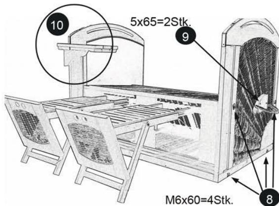
**8.** Die Seiten des Unterkorbes werden mit jeweils 4 Schrauben M6 x 60 mm montiert.
