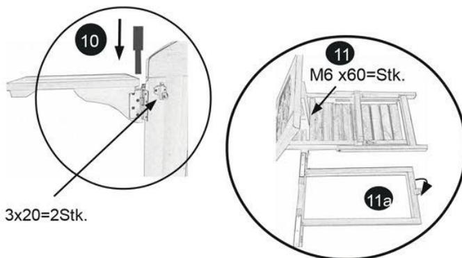
**10.** Der Cocktailltisch wird mit einem Bolzen durch die beiden Scharnierteile angebracht. Den Schnapper montieren Sie mit 2 Holzschrauben 3 x 20 mm an dem vorgebohrten Seitenteil.
