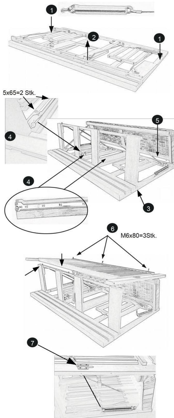
**1.** Montieren Sie die Ringbolzen der Rückholfedern an den äußeren Latten des Bodens.
