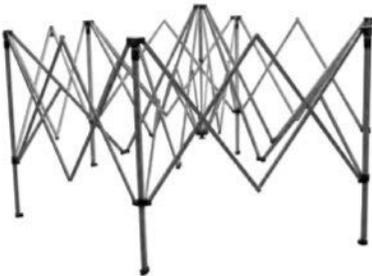
Ziehen Sie die Standbeine zur ersten Stufe aus. Lösen Sie Kugelsperren, indem Sie auf die Kugel drücken und die Teile zusammenschieben oder auseinanderziehen. Die Kugelsperren müssen hörbar einrasten.
