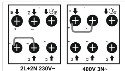
Das Kabel für das Induktionskochfeld muss vom Typ H05VV-F 5X2,5 mm<sup>2</sup> / 60227 IEC 53 sein. Auf dem Boden
