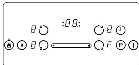
L'immagine sopra mostra il display dell'elemento riscaldante anteriore destro che indica la funzione frittura.
