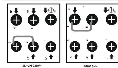
Pour les plaques à induction, le câble doit être H05VV-F 5X2,5 mm<sup>2</sup> 60227 IEC 53 .. Vous trouverez le schéma de raccordement à l'arrière de votre appareil.
