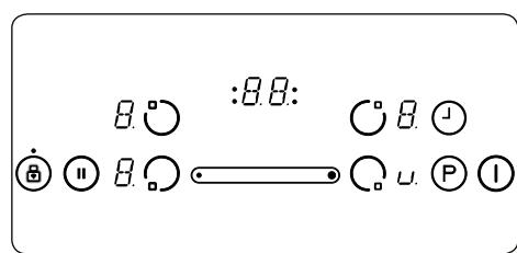
Nell'immagine sopra, il display dell'elemento riscaldante anteriore destro indica la funzione di mantenimento del calore.
