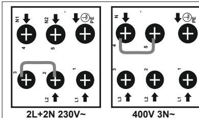
Per la piastra a induzione, il cavo deve essere un H05VV-F 5X2,5 mm<sup>2</sup> 60227 IEC 53 .. Lo schema delle connessioni è indicato sulla parte posteriore dell'apparecchiatura.
