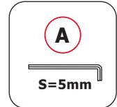
Einen Sechskantschlüssel zur Einstellung der Höhenspannung des Gasfederarms verwenden, damit unterschiedlich schwere Monitore in jeder Position ruhig gehalten werden.
