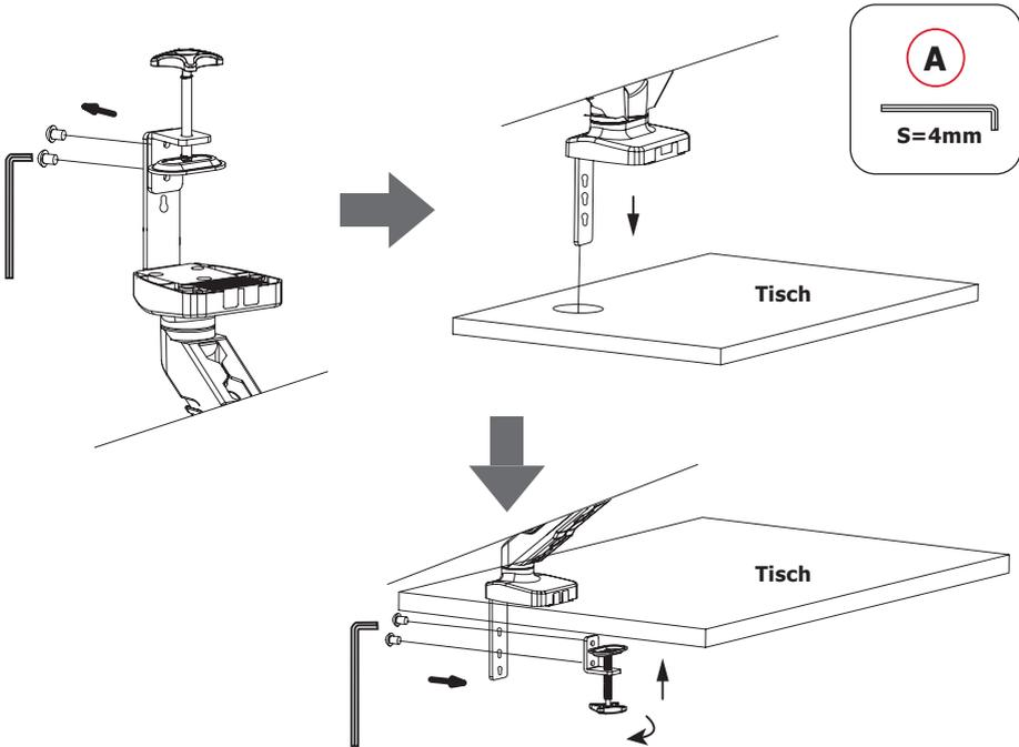
**Beide Schrauben an der Halterung lösen, Halterung durch die Tischöffnung führen und wieder zusammensetzen. Die beiden gelösten Schrauben festziehen.**
