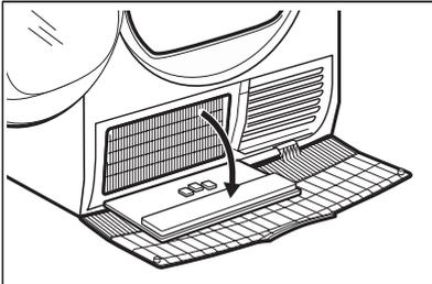
5. Entfernen Sie nach Bedarf die Flusen aus dem Kondensator und seinem Fach. Hierzu können Sie einen feuchten Lappen und/
