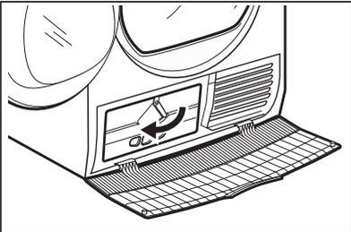
4. Klappen Sie den Kondensatordeckel nach unten.
