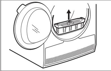
2. Öffnen Sie die Kondensatorabdeckung.
