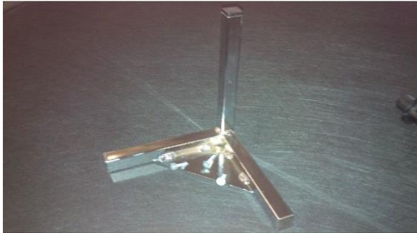
2.) Montieren Sie die FüÙe mit je 3 Schrauben (Schraube c 5mm) in den Ecken des Daybettes
