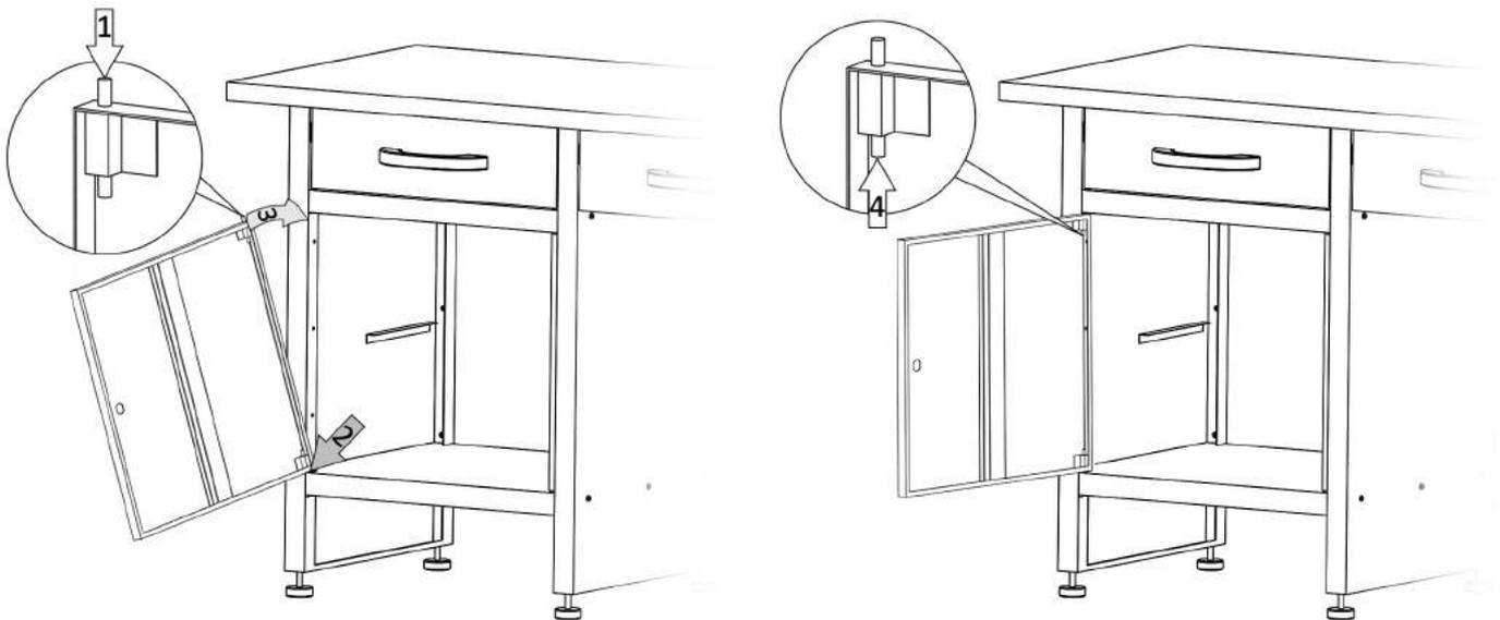
Drücken Sie den oberen Splint des Türscharniers nach unten und montieren sie die Tür (7) wie in der Abbildung beschrieben an den Korpus. Um die Tür zu fixieren, drücken Sie den oberen Splint wieder in die vorgesehene Öffnung im Rahmen. Zum Bewegen der Splinte sind gegebenenfalls seichte Schläge mit dem Hammer nötig.
