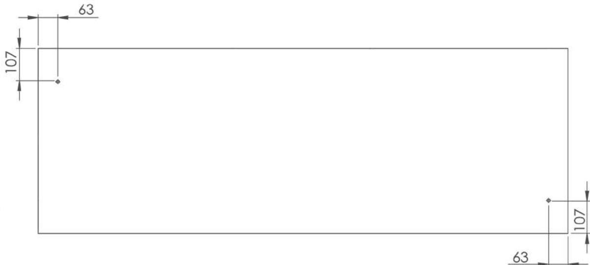
Markieren Sie die benötigten Befestigungspunkte auf der Unterseite der Arbeitsplatte (20).
