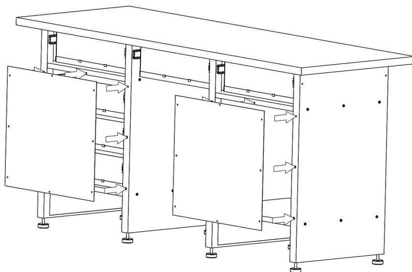
Schrauben Sie beide Rückwände (5) an die Konstruktion.
