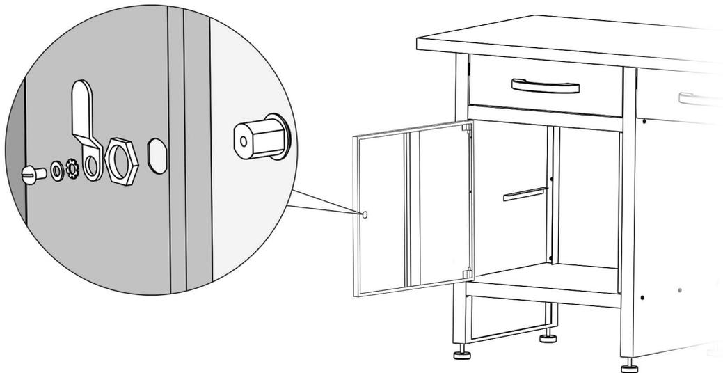
Stecken Sie den Schließzylinder des Schlosses (19) durch die in der Tür vorgesehene Öffnung und fixieren Sie ihn wie in der Abbildung. Prüfen Sie vorher, ob die Schließrichtung korrekt ist.
