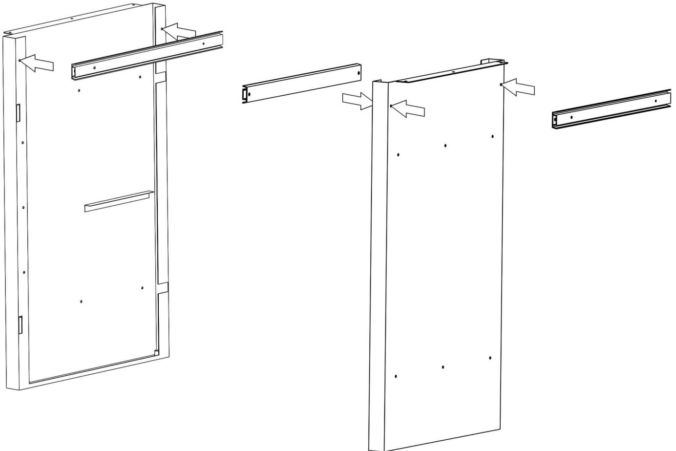
Schrauben Sie eine Schubladenführung (15) an die Seitenwand 1 (1) und zwei Schubladenführungen an beide Seiten der Seitenwand 2 (2).
