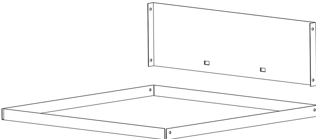
Setzen Sie die Schubladenrückwand (12) auf die Rückseite des Schubladenbodens (14). Schrauben Sie die beiden Teile noch nicht zusammen! Achten Sie beim Verschrauben der Einzelteile darauf, dass die Schraubenköpfe außen sitzen und die Muttern sowie Unterlegscheiben innen sitzen.
