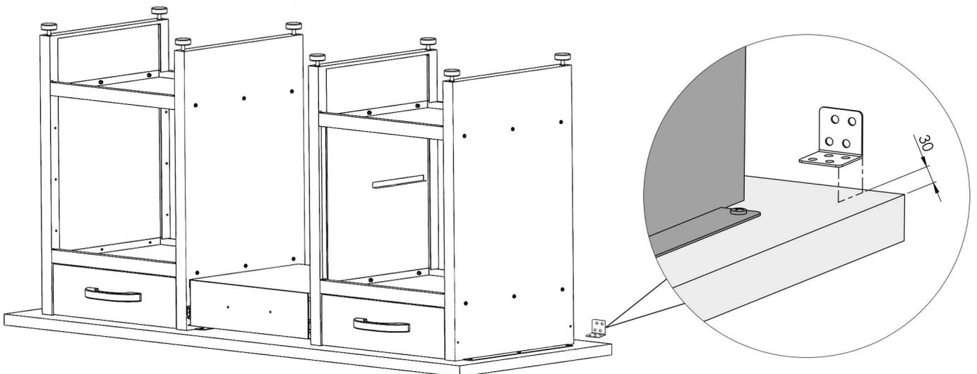
Schrauben Sie die beiden Anbauwinkel (18) mit Hilfe von jeweils vier Schneidschrauben (23) mit einem Abstand von 30 mm zu den Ecken auf der Rückseite der Arbeitsplatte. Stellen Sie die Werkbank wieder auf.
