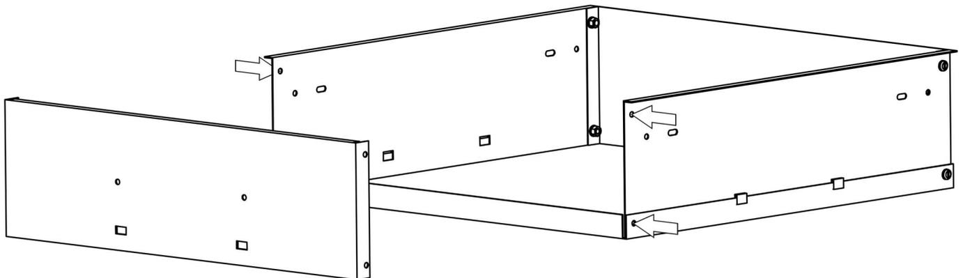
Schrauben Sie die Schubladenfront (11) an die Schubladenseitenwände.
