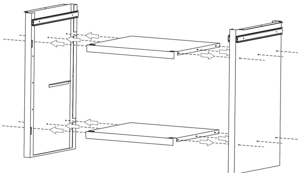
Schrauben Sie die beiden Fachböden (6) an die Seitenwand 1 und Seitenwand 2.
