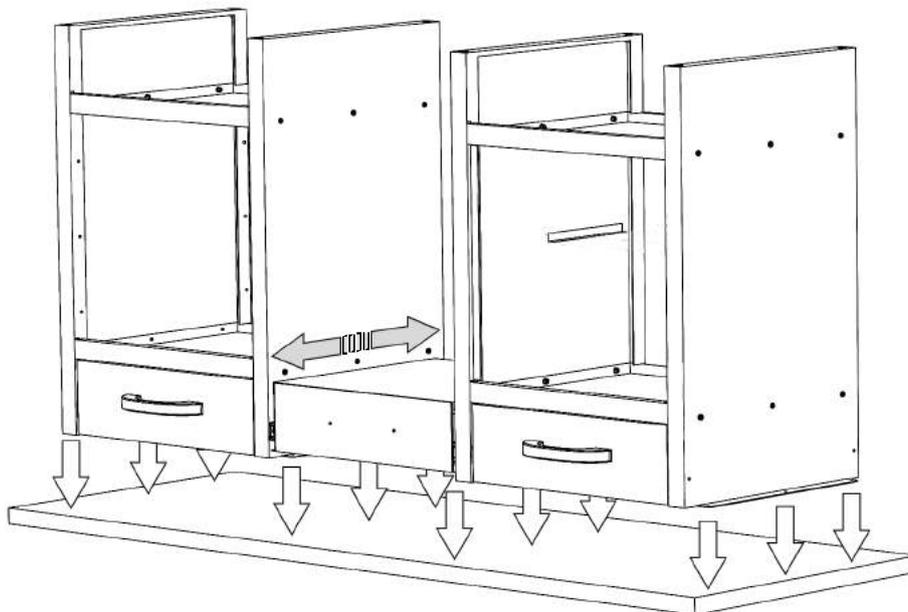
Kippen Sie die Werkbank nach hinten, um diese auf die Arbeitsplatte (20) zu setzen. Schrauben Sie mit Hilfe von zwölf Schneidschrauben (23) die Konstruktion auf die Markierungen der Unterseite der Arbeitsplatte. Schieben Sie die mittlere Schublade nach vorn oder hinten heraus, um die mittleren Schrauben leichter erreichen zu können.
