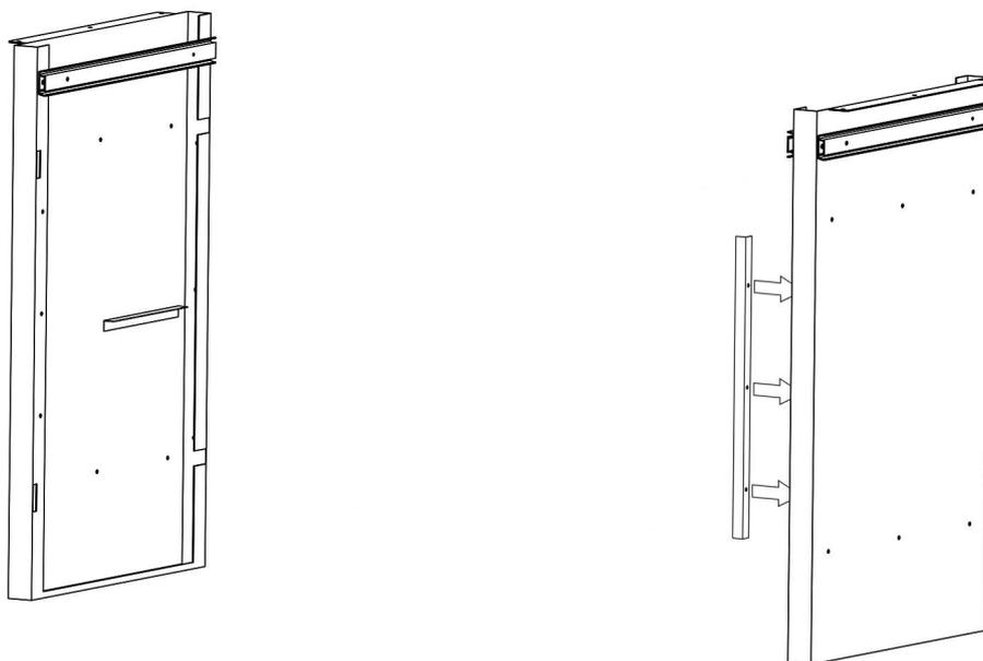
Schrauben Sie den Türanschlag (8) an die linke Seite der Seitenwand 2 (2).
