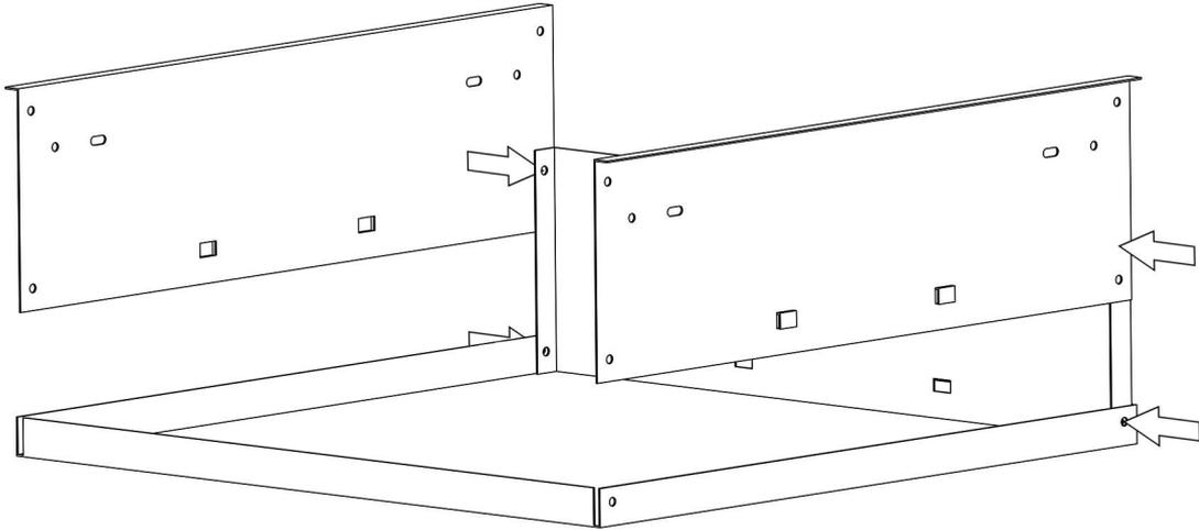
Schrauben Sie jetzt beide Schubladenseitenwände (13), die Schubladenrückwand sowie den Schubladenboden zusammen.
