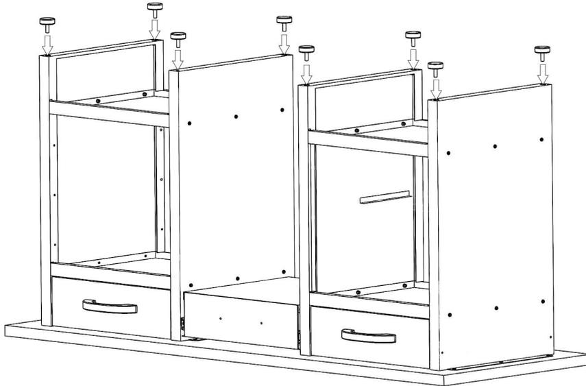
Schrauben Sie die acht Justierfüße (17) in die Seitenwände der Werkbank. Schrauben Sie nun die letzte Schubladenblende an (siehe Schritt 10).
