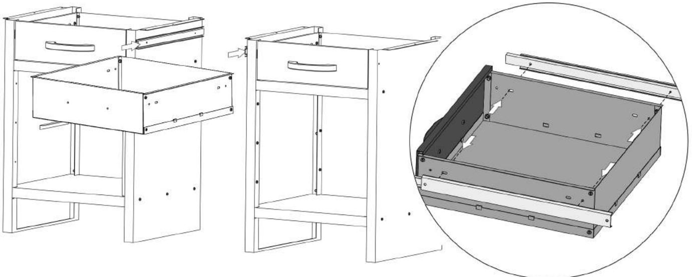
Schrauben Sie die drei oberen Schubladen an die Schubladenführungen. Verwenden Sie in der Mitte die Schublade ohne Blende.
