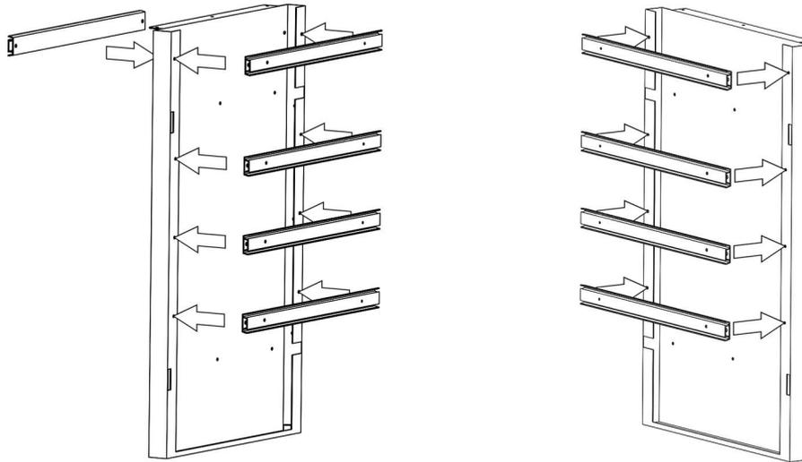
Schrauben Sie eine Schubladenführung (15) an die linke Seite und vier Schubladenführungen an die rechte Seite der Seitenwand 3 (3) und vier Schubladenführungen an die Seitenwand 4 (4).
