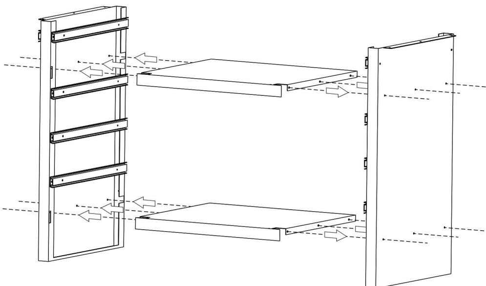
Schrauben Sie die beiden Fachböden (6) an die Seitenwand 3 und Seitenwand 4.
