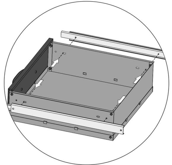
Ziehen Sie die Schubladenführungen der restlichen Schubladenplätze heraus und schrauben Sie die Schubladen an die Schubladenführungen.
