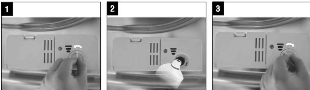
Zum Öffnen des Behälters, die Kappe in Pfeilrichtung nach links drehen und herausheben.
