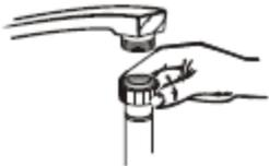
Verbinden Sie den Wasserzuleiterschlauch mit einem  $\frac{3}{4}$ " Gewindeanschluss und ziehen Sie das ganze gut fest.
