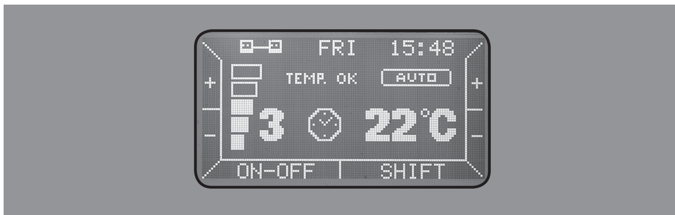
Abb. 11: Display-Anzeige bei Automatikbetrieb
