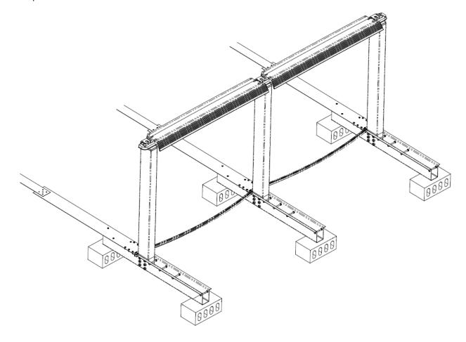
Überprüfen Sie genau den Abstand zwischen allen Stützpfosten (Maß S im Kapitel 7.1) und deren senkrechte Ausrichtung. Es muss ebenfalls überprüft werden, dass es zwischen den einzelnen Pfosten keine Höhenunterschiede gibt.
