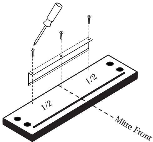
Montieren Sie die Griffleiste wie angezeigt mittig an der Front!
