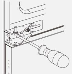
14. Den Stift vom oberen Scharnier in die Vorrichtung der oberen Gerätetür aufstecken.
