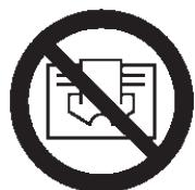
**WICHTIG:** Zum Vermeiden eines Überhitzens das Gerät in keiner Weise abdecken. Keine Gegenstände oder Textilien auf das in Betrieb gesetzte Gerät legen. Angegeben ist dies klar und deutlich auf dem Gerät oder durch das Symbol!
