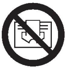
**BELANGRIJK:** Om oververhitting te voorkomen dient u het apparaat nooit te bedekken. Plaats nooit voorwerpen of dekens op het apparaat terwijl dit in werking is. Dit wordt duidelijk schriftelijk op het apparaat vermeldt, of aangegeven door het symbool
