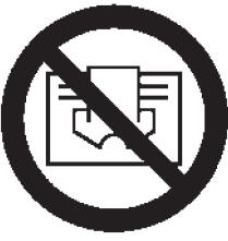
**IMPORTANT** : pour éviter tout risque de surchauffe ne couvrez jamais l'appareil. Ne posez jamais ni objet, ni couverture, sur l'appareil lorsqu'il est en marche. Cette interdiction est écrite clairement sur l'appareil et illustrée par ce symbole.
