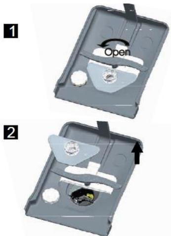
Schritt 2: Hauptfilter anheben
