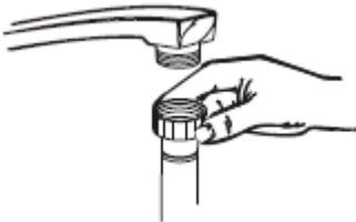
Verbinden Sie den Wasserzufuhrschlauch mit einem  $\frac{3}{4}$ " Gewindeanschluss und ziehen Sie das Ganze gut fest.
