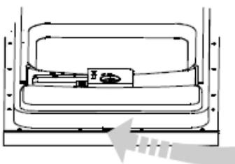
Zum Reinigen der Türumrandung ein weiches Tuch verwenden. Zum Verhindern, dass Wasser in die Türverriegelung und die elektrischen Elemente eindringt, niemals Sprühreiniger oder ähnliches verwenden.
