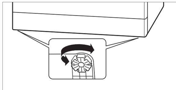
3. Um Unebenheiten des Bodens auszugleichen und den Geschirrspüler waagrecht auszurichten, können Sie die vier Gerätefüße heraus- oder hineindrehen. In den Gerätefüßen sind ringsherum Schlitze angebracht. Stecken Sie hier einen Schraubendreher hinein und drehen Sie damit den Gerätefuß. Verwenden Sie zum Ausrichten des Geschirrspülers eine Wasserwaage.
