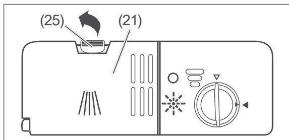
1. Ziehen Sie den Verschluss (25) der Spülmittelkammer (21) nach hinten. Der Deckel springt auf.
