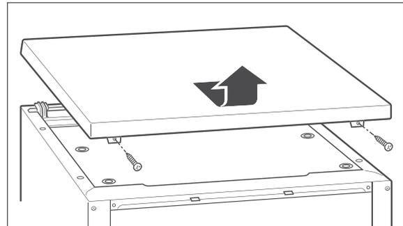
2. Lösen Sie die beiden Schrauben auf der Rückseite der Abdeckplatte und nehmen Sie diese ab.
