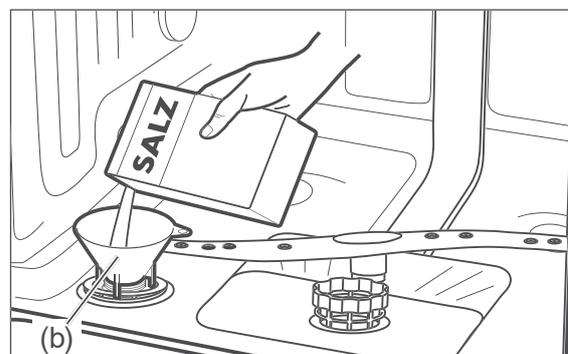
4. Setzen Sie den mitgelieferten Einfülltrichter (b) auf die Kammeröffnung.
