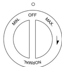
Bei einer durchschnittlichen Raumtemperatur von 20 °C bis 25 °C für Haus- und Bürogebrauch den Temperaturregler auf Stufe NORMAL stellen.
