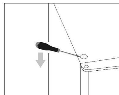
5. Scharnierloch-Abdeckung der Gerätetür links oben entfernen und rechts in das Scharnierloch einstecken.
