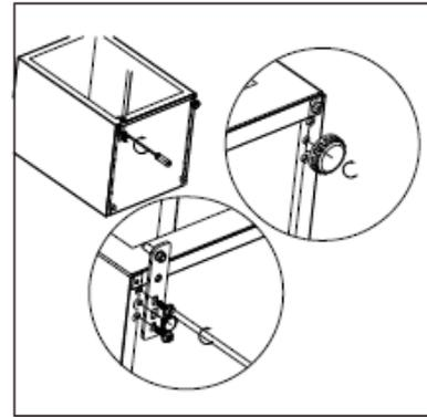
11. Gerätetür auf den Stift des unteren Scharniers aufsetzen und vorsichtig schließen.
