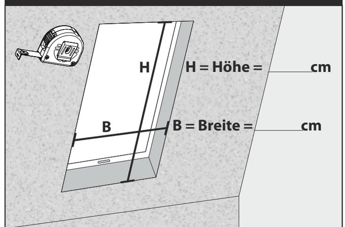
Messen Sie von Dachfenster-Laibung Innenkante zu Innenkante (lichtes Maß) und notieren sich das Ergebnis.
