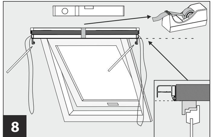
**8** Vormontierte Plisseekassette anhalten. Dabei liegt die hintere, untere Kante der Plisseekassette bündig an der Laibungskante. Mittig und horizontal ausrichten. Bohrlöcher anzeichnen.
