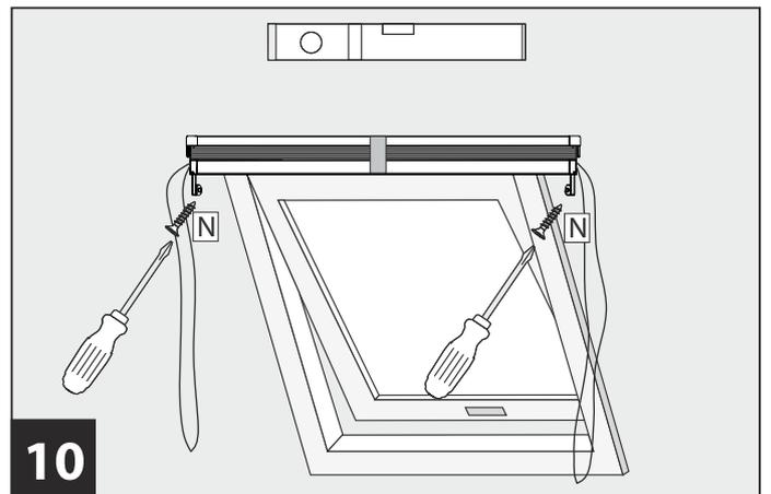
**10** Vormontierte Plisseekassette erneut anhalten und mit Senkkopfschrauben **N** befestigen.
