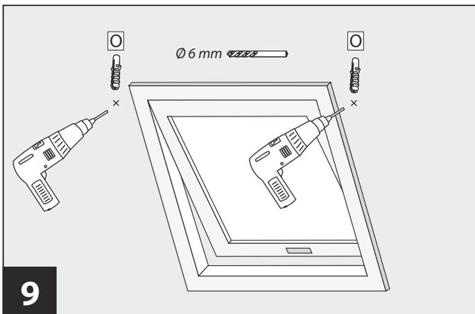
**9** Gekennzeichnete Positionen mit einem  $\text{\O} 6 \text{ mm}$  Bohrer vorbohren und Dübel **O** einsetzen.
