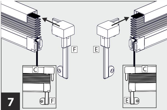
**7** Eckverbinder links **E** und rechts **F** auf die Plisseekassette **C** aufstecken.
