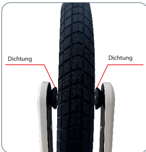
bei der Montage des Rades die Schraube durch die „Dichtung - Rad - Dichtung“ führen und dann die Schraube mit einem Schraubenschlüssel festziehen
