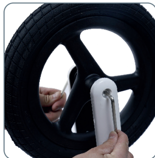
Når du monterer hjulet, før skruen gjennom "pakning - hjul - pakning" og stram deretter skruen med en skiftenøkkel.
