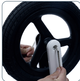
bei der Montage des Rades die Schraube durch die „Dichtung - Rad - Dichtung“ führen und dann die Schraube mit einem Schraubenschlüssel festziehen
