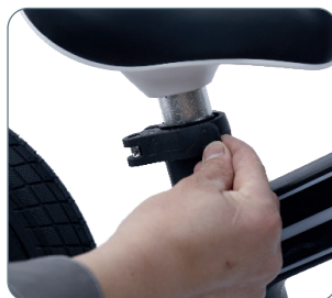
Setejustering (åpne og løft, juster til riktig høyde og lås)
