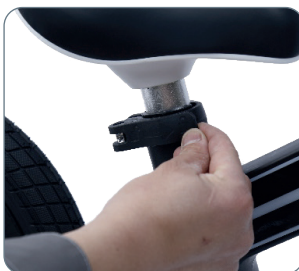
Sitzverstellung (aufklappen und anheben, die entsprechende Höhe einstellen und verriegeln)
