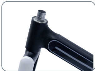
Lenker montieren (Lenker nach vorne)
