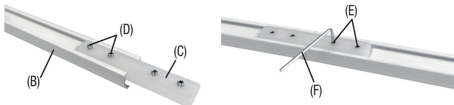
**Achtung: Verbinden Sie zuerst die Profile mit den Profilverbindern und setzen Sie erst danach mit der weiteren Montage fort.**
