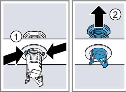
5. Unter fließendem Wasser die Siebelemente reinigen.
