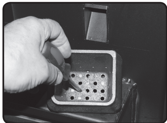
Abb. 14c: Reinigung der Luftöffnungen mit einem Werkzeug
