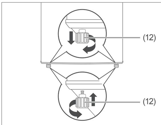
5. Gleichen Sie Unebenheiten im Untergrund mithilfe der beiden vorderen Schraubfüße (12) aus.
